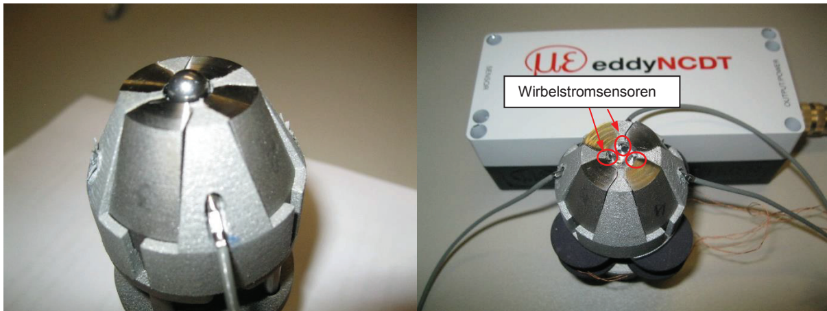
Abbildung 71: Das Magnetlager-Modul mit Positionssensoren von der Fa. micro-epsilon.
