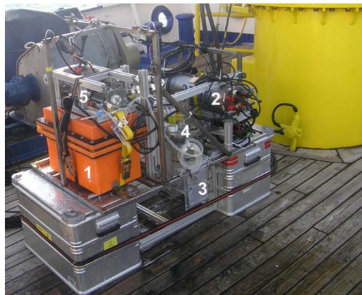
Abbildung 25: Das RISS (Rhizon-In situ-Sampling-System) vor seinem Einsatz in der Ostsee. 1: Tiefseebatterie; 2: Druckgehäuse mit der Steuerung; 3: Rhizonenplatte; 4: Kammer; 5: Peristaltikpumpe. Ebenfalls integriert sind: ISUS-Nitratsensor, Aanderaa-Sauerstoffoptode, Spritzenprobennehmer mit 12 Spritzen.
