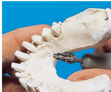
Abb. 9: Fräser für Gips müssen große Mengen an Spänen aufnehmen. Für feuchte Gipse verwendet man supergrobe Kreuzverzahnungen.
