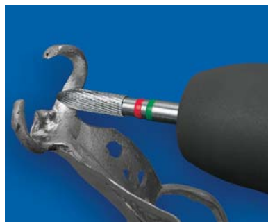
Abb. 12: Für zäh/hartes Titan hat sich die FST-Verzahnung bei 15.000 U/min bewährt.
