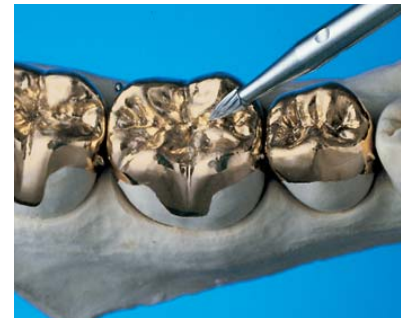
Abb. 10: Für Edelmetalle verwendet man feine und feinste Kreuzverzahnungen mit einer Richtdrehzahl von 15.000 bis 25.000 Umdrehungen pro Minute.
