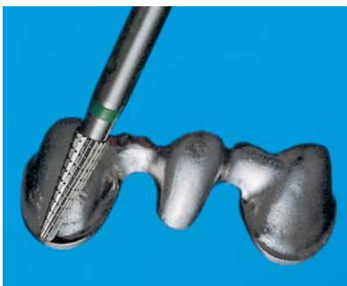
Abb. 11: Nichtedelmetalle sind hart und entwickeln Hitze. Am besten fräst man mit Kreuzverzahnungen oder grober, gewundener Spiralverzahnung bis 15.000 U/min.
