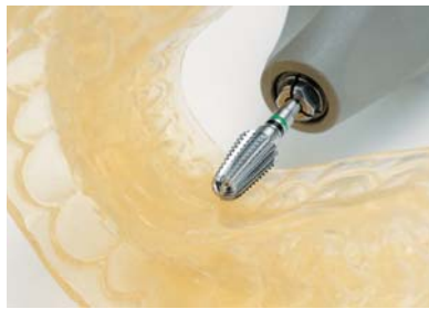
Abb. 15: Softkunststoffe werden am besten mit grober, schnittfreudiger Verzahnung und Querhieb bearbeitet.
