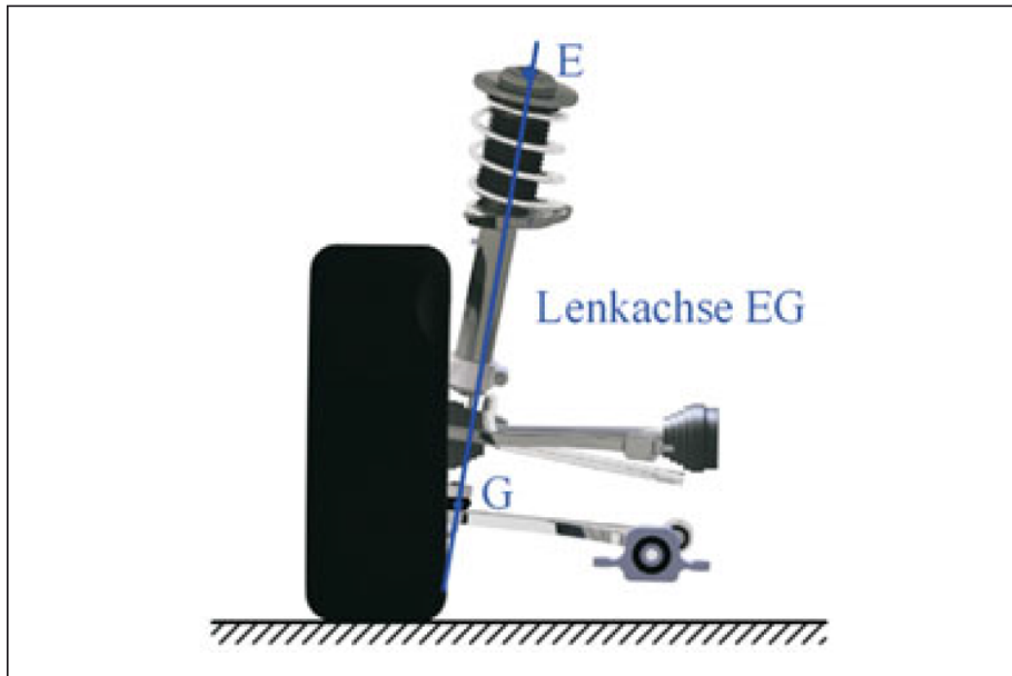
Lenkachse (Achsschenkelachse), Quelle [Fahrwerk]
