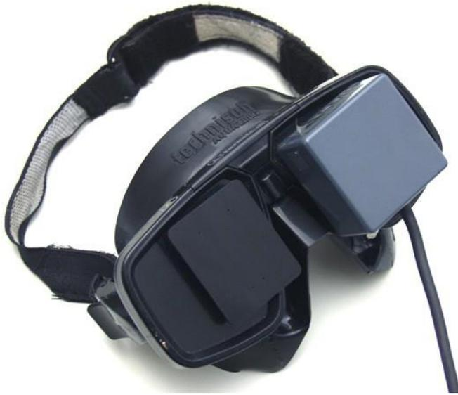
Abb.10 : Lichtausschließende Maske zur Registrierung von Augenbewegungen mit umsteckbarer Videokamera vor dem linken Auge (Originalphoto)
