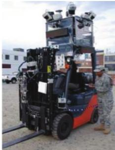
**Abbildung 2.7:** Sprachgeführte Systeme am Beispiel eines autonomen Gabelstaplers von [TKD<sup>+</sup>11]. Das System kann bestimmte Stapler-Aufgaben automatisch durchführen.
