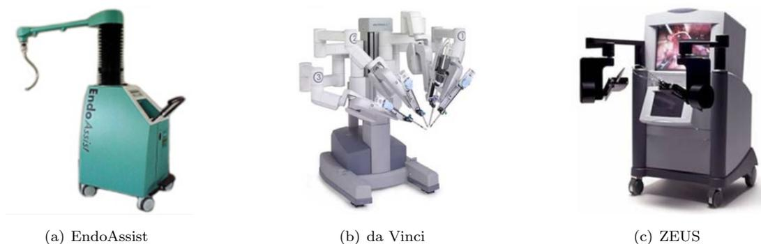
**Abbildung 2.5:** Medizinische kameratragende Systeme. Diese Systeme tragen ebenfalls eine Kamera und sind vergleichbar mit automatischen Kamerasystemen. Allerdings liegt hier der Fokus auf dem ruhigen Tragen der Kamera.
