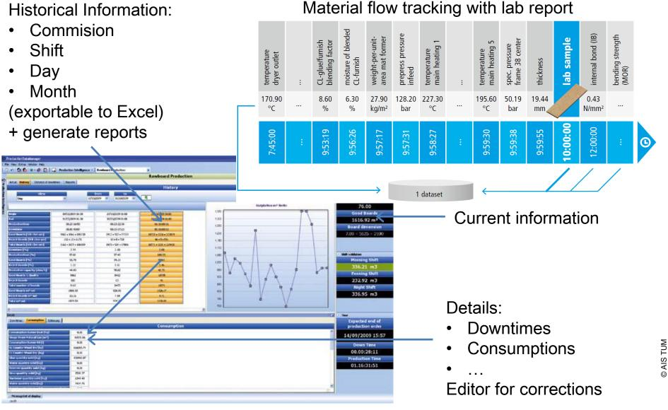
Source: Siempelkamp Maschinen- und Anlagenbau GmbH & Co. KG, Prod-IQ
