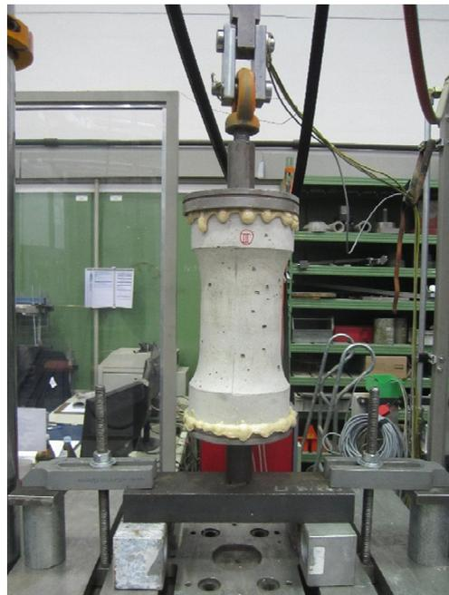
Versuchsaufbau zur Bestimmung der zentrischen Zugfestigkeit mit gelenkiger Lagerung oben und unten (Kalottenlagerung)
