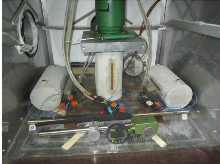
Abbildung 4.11: Kriechkörper und Schwindkörper
