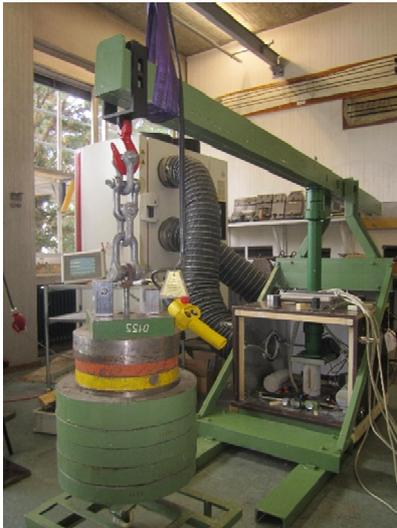
Abbildung 4.10: Totlastrahmen und temperierbare Kiste zur Durchführung der Kriechversuche
