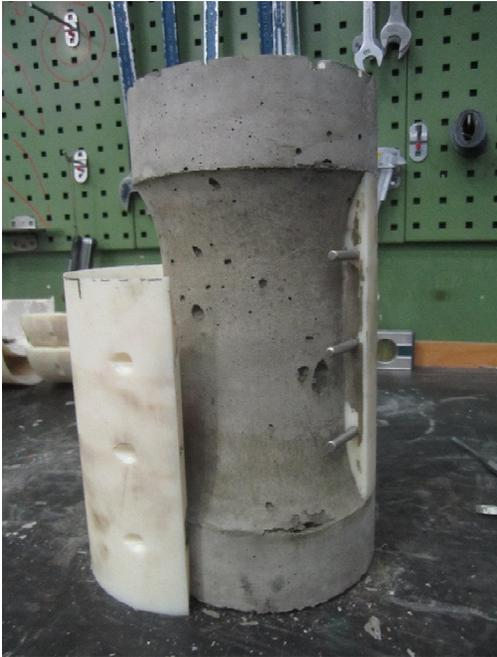
Ausgeschalteter Probekörper mit teilbaren Inlays
