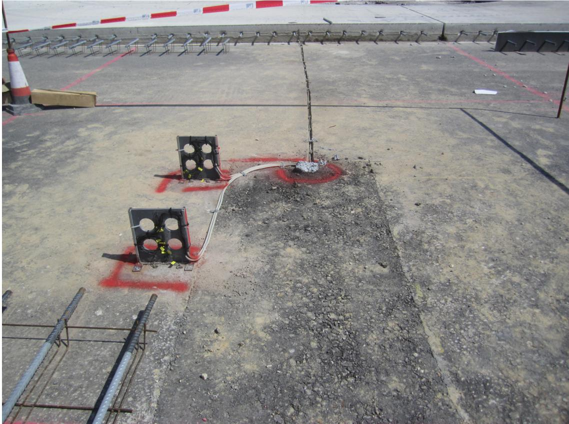
Messaufbau beim Lastfall 1: Betoneinbau Sommer Abend
