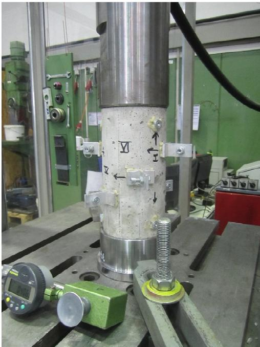
Abbildung 4.14: Versuchsaufbau zur Bestimmung der Querdehnzahl
