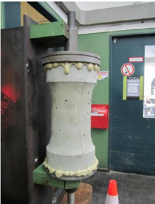
Mit Lasteinleitungsplatten verklebter Probekörper in der Klebevorrichtung
