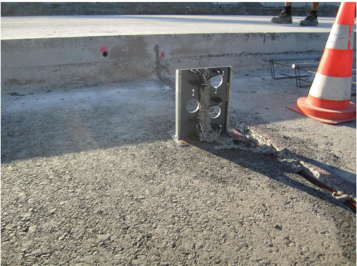
Messaufbau beim Lastfall 3: Betoneinbau Sommer Mittag
