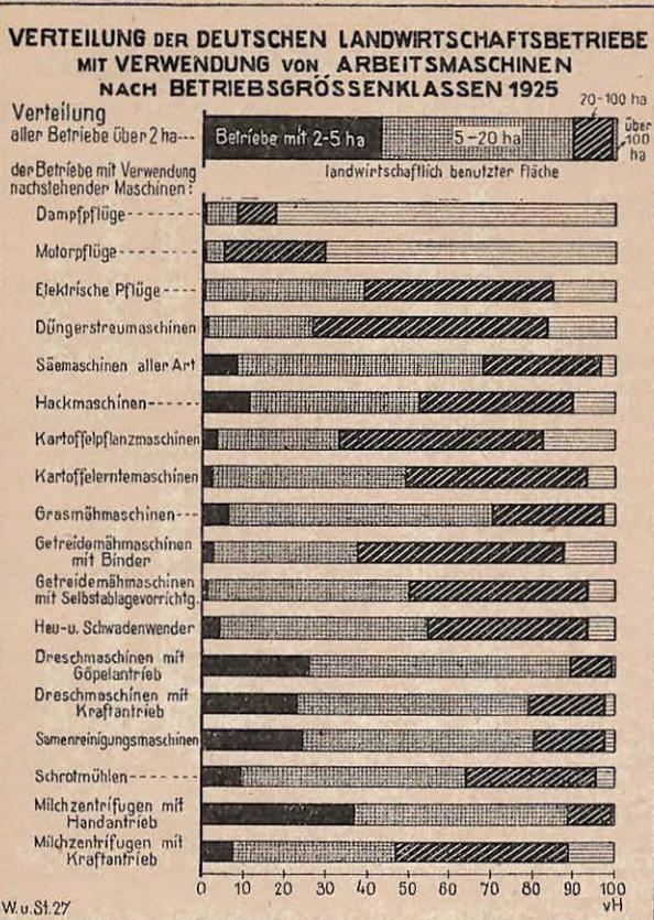
nehmen unter den Kraftpflügen die Motorpflüge ein, mit denen fast 7 000 Betriebe arbeiten. Demgegenüber steht die Zahl der Betriebe, die Dampfpflüge verwenden (1 618), zurück. Sehr gering ist die Verwendung elektrischer Pflüge, die nur in 237 Betrieben festgestellt werden konnte.
