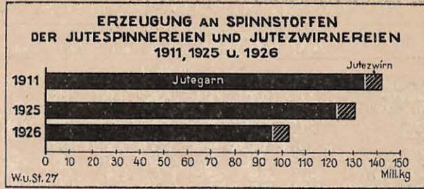
Die Erzeugung an Endprodukten betrug 1925 rund 124,5 Mill. kg eindrähtige Garne und rund 6,5 Mill. kg Zwirne. Im Jahre 1926 wurden an Endprodukten rund 97,3 Mill. kg eindrähtige Garne und rund 5,5 Mill. kg Zwirne erzeugt. Es wurden also nur etwa 5 vH der Garne verzwirnt.
