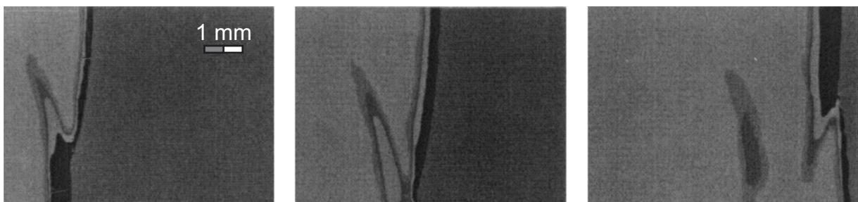
**Abbildung 5.18:** Reaktionsfortschritt einer Marginaldetonation eines stöchiometrischen H<sub>2</sub>-O<sub>2</sub> in 60% Ar Gemisches, numerische Simulation von Oran [Ora99].
