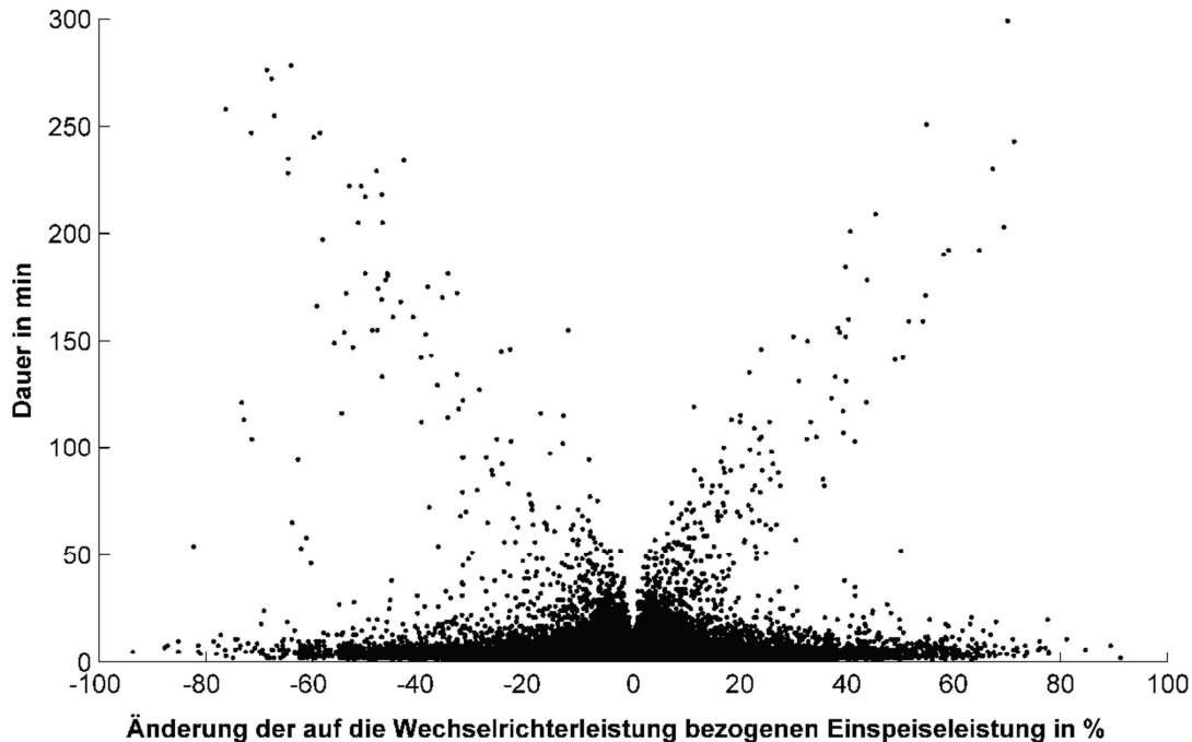
Bild 2.4: Darstellung der aufgetretenen Änderungen der Einspeiseleistung und deren Dauer basierend auf Messdaten der PV-Anlage Messe München für das Jahr 2005
