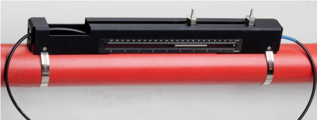
Abbildung 17 Absenken der Messwandler auf das Rohr
