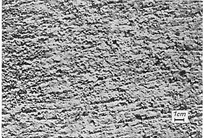
Bild 5 Junger Laborbeton ( W/Z = 0,40 , 3,5 % Luftporen und Epoxyharz-Imprägnierung) nach 90 Frost-Tausalz-Wechseln (Zementhaut erhalten) [16]
