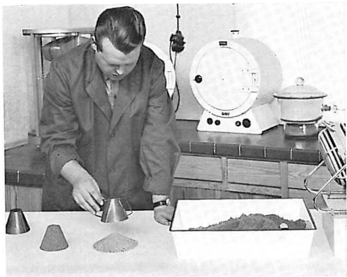
Bild 3 Bestimmung der Kernfeuchte von Sand mit dem Kegel-Stand-Versuch. Der linke Sandkegel ist standfest und enthält noch Oberflächenfeuchte; der rechte Kegel zerfällt beim Ziehen der Form, der Sand ist oberflächentrocken
