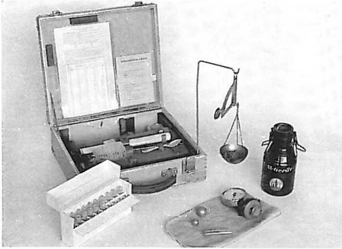
Bild 6 CM-Gerät; Stahldruckflasche (offen), Verschuß mit Manometer, Carbidampullen, Stahlkugeln und Waage (am Transportkasten befestigt)
