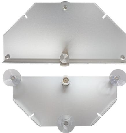
Klebelehre zum Verkleben der Glasbruchsensoren. Die Klebelehre ist so konstruiert, dass der Abstand vom Sensor zum Rahmen automatisch gegeben ist. Darüber hinaus gewährleistet die Klebelehre während des Aushärtevorgangs des Klebers einen gleichbleibenden Druck auf die Sensoren.
