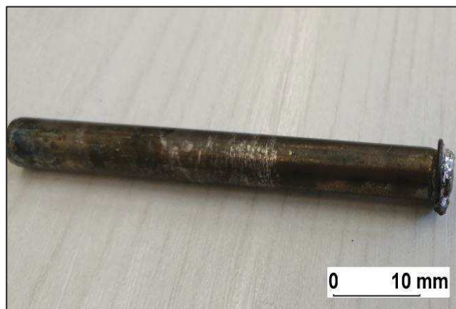
Abbildung 16: Tauchrohr nach dem Bleiversuch
