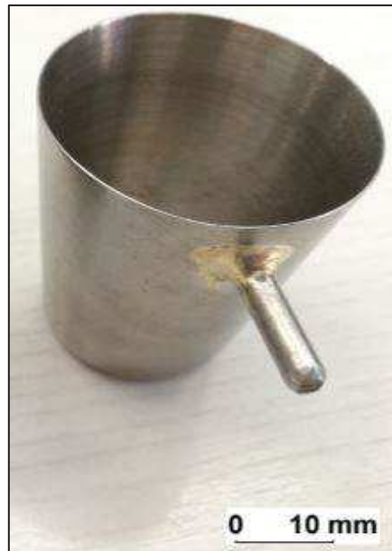
Abbildung 14: Schmelztiegel mit angelöteten Bolzen
