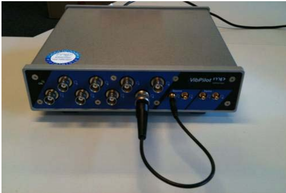
Kurzschlussstest mit einem m+p VibPilot Frontend
