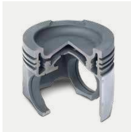
مكبس صلب احادي الكتلة مطروق ملحوم لحامًا احتكاكيًا مزدوجًا
