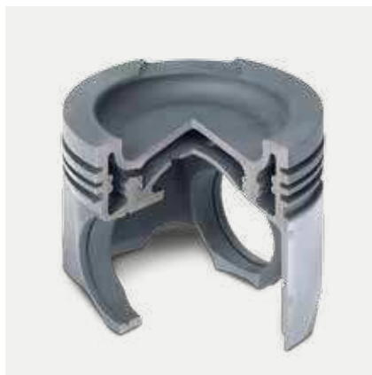
Pistón de acero monobloque forjado con soldadura doble por fricción
