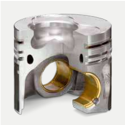
Dieselskolben mit Kühlkanal, Bolzenbuchse und Ringträger
