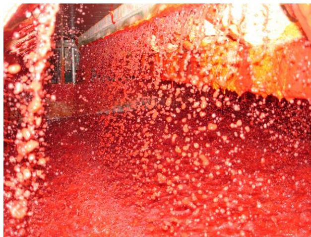
Abb. 10: Aufnahme des nach unten abströmenden Wassers unter dem Sieb der PM 3.
