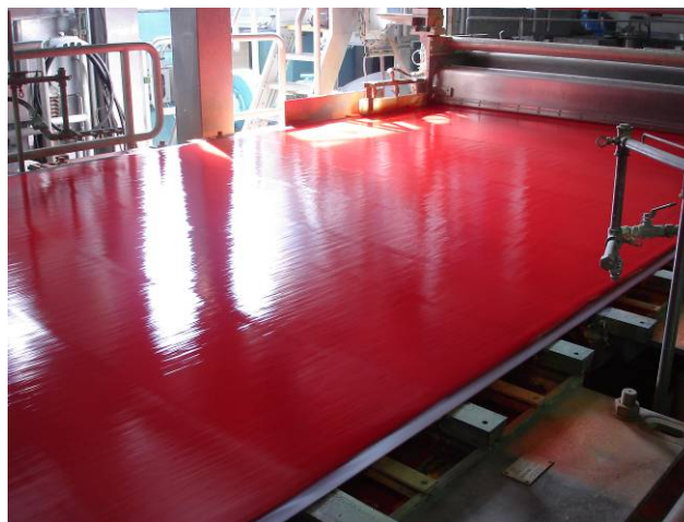
Abb. 9: Aufnahme der PM 3, bei der die unter dem Sieb quer zur Bahn liegenden Entwässerungsleisten erkennbar sind.
