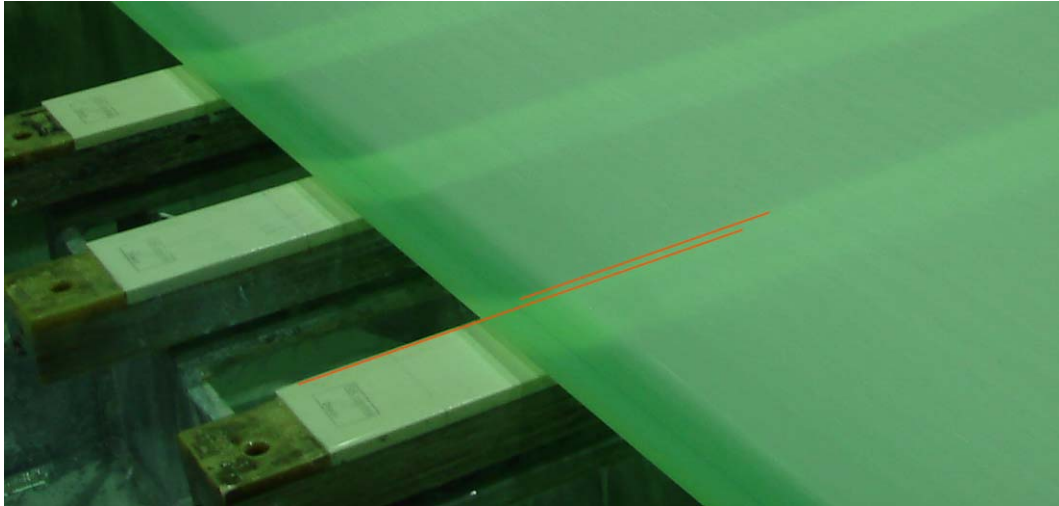
Abb. 11: Aufnahme eines Foils der PM 5 mit durch Brechung optisch versetzter Kante.
