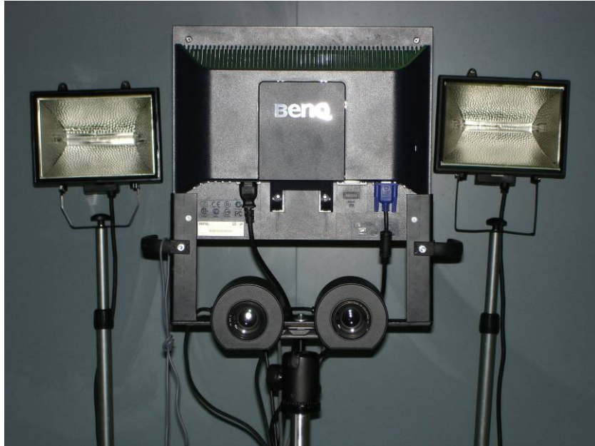
Abb. 27: Der Messkopf des OWL-Messsystems, mit dem Vor-Ort-Bildschirm und den beiden Objektiven, die dem System den Namen (OWL = deutsch „Eule“) gegeben haben. Links und rechts zwei herkömmliche Bauleuchten, die als Lichtquelle dienen und auf der gegenüberliegenden Seite des Siebes aufgestellt werden.
