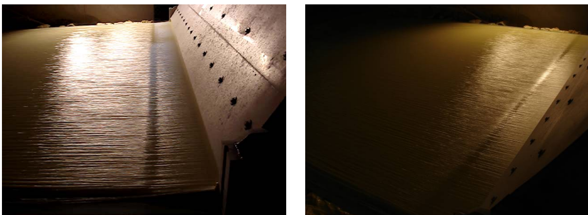
Abb. 12: Auftrefflinie des Suspensionsstrahles auf dem Sieb auf die Vorderkante des Brusttisches.
