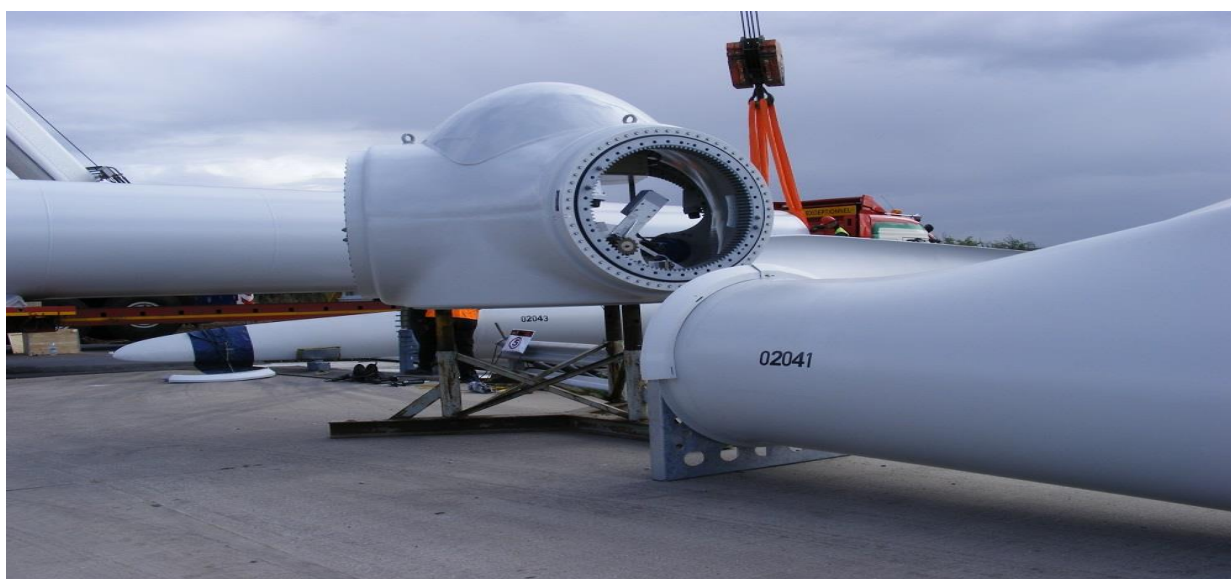
Figur 12, Nav til EWT vindturbin før det sammenkobles med vinger.
