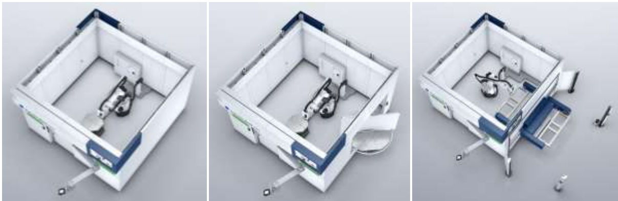
Abb. 37: Dreh - Kipp - Positionierer (Links), Zwei - Stationen - Drehtisch (Mitte), Rotationswechsler (Rechts) (Quelle: /51/)
