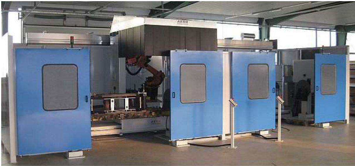
Abb. 44: Schweißroboter - Anlage Typ ASA - 1003 (Quelle: /14/)
