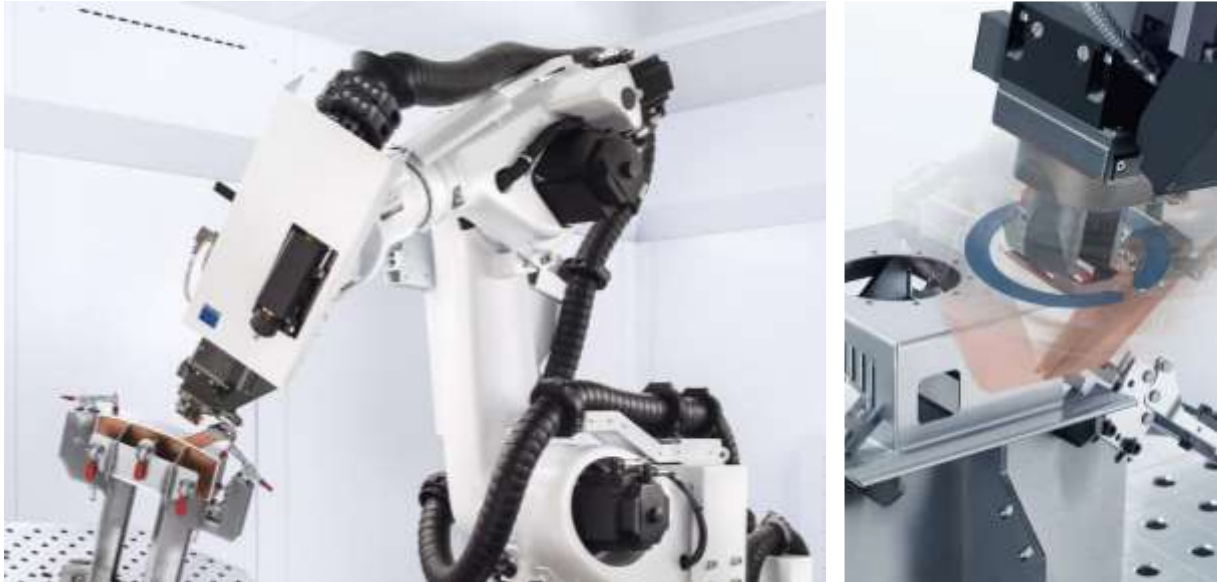
Abb. 36: High - Accuracy - Roboter (Links), Bearbeitungsoptik mit einem drehbaren Modul (Rechts) (Quelle: /51/)
