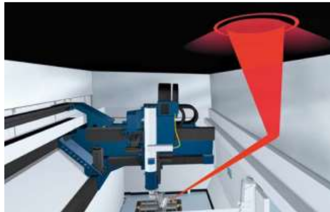
Abb. 43: Hochreflektierende Seitenwand und absorbierendes Dach (Quelle: /51/)
