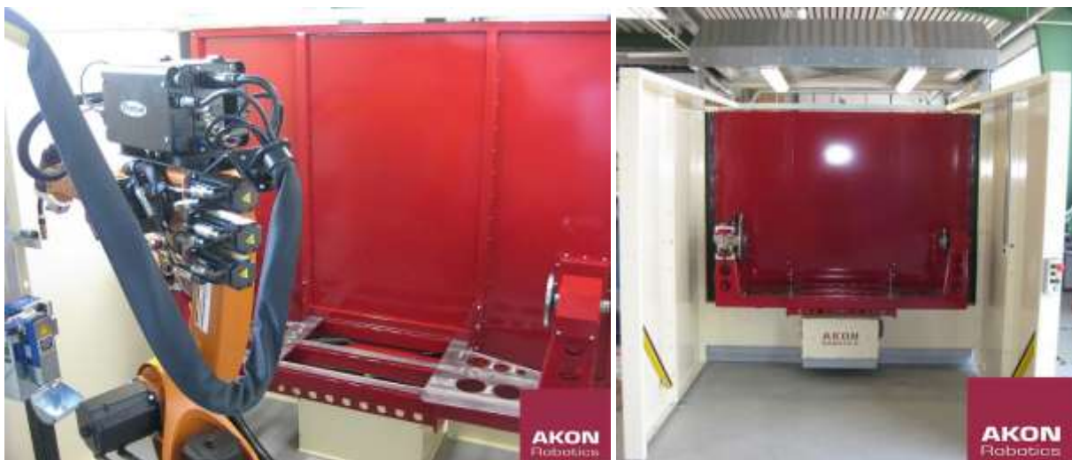
Abb. 46: KR6R1820 arc HW Roboter mit einer Dreh - Schwenk - Positioniereinheit (Quelle: /14/)
