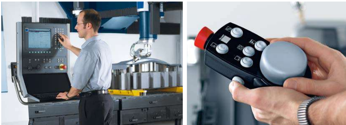
Abb. 42: Ergonomisches Bedienpult (Links), 6 - D - Maus (Rechts) (Quelle: /51/)
