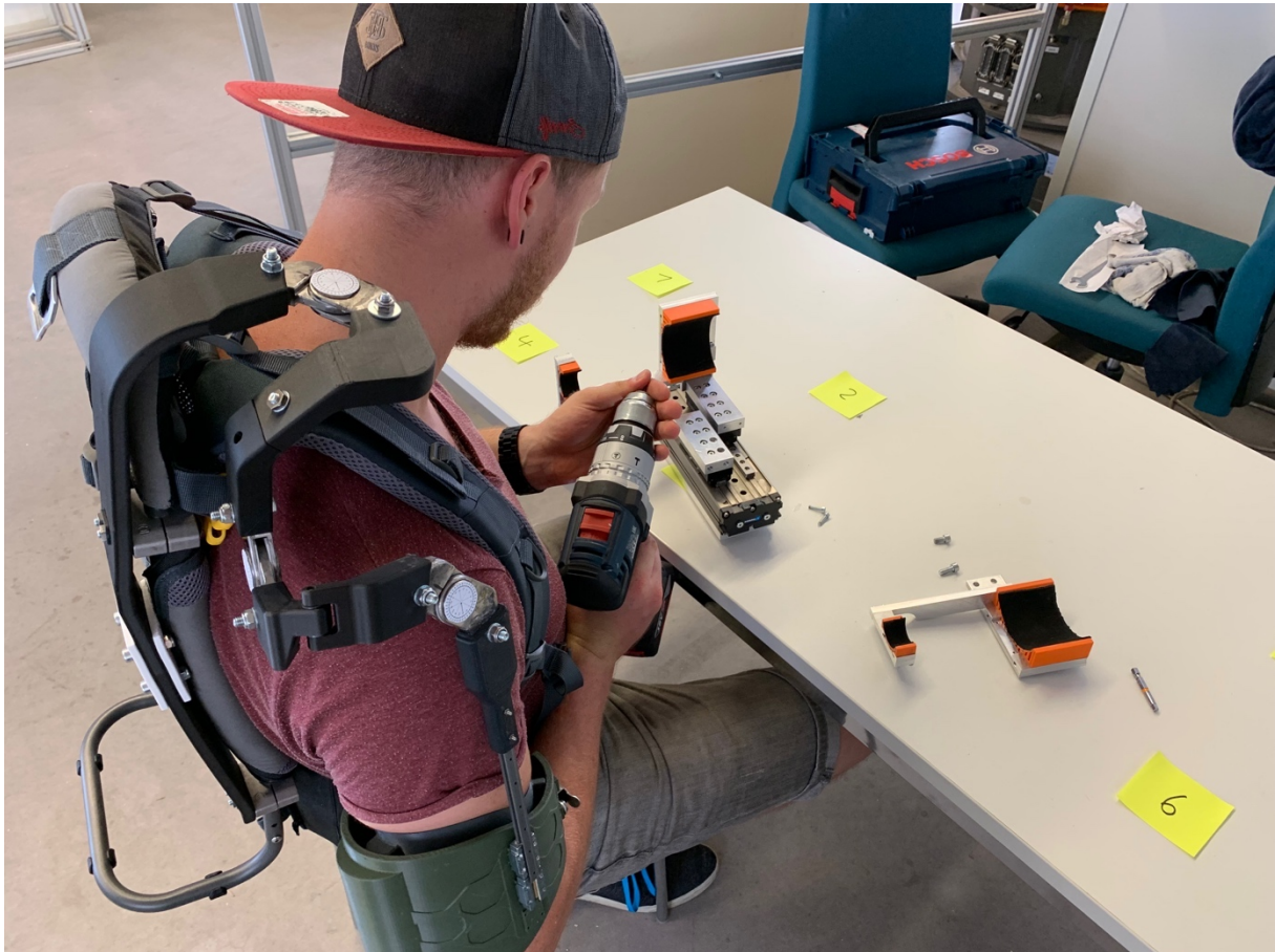
Abbildung 48: Montagetest einer kleinen mechanischen Einheit
