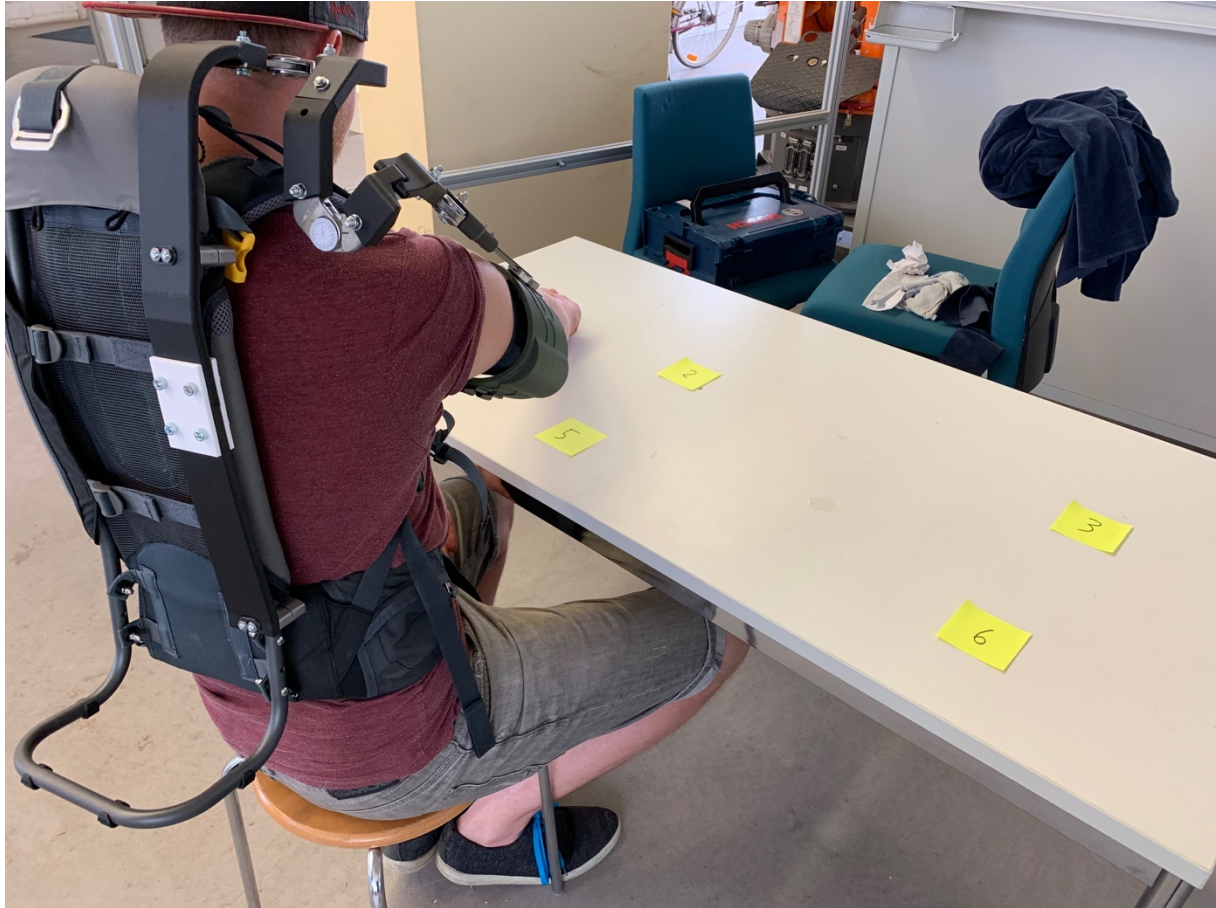
Abbildung 47: Test des Bewegungsfreiraums
