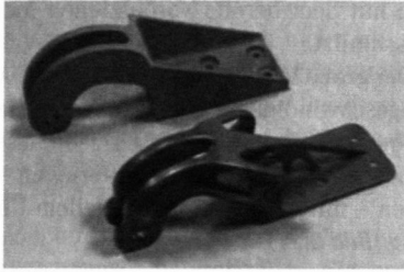
Bild 2.18: Airbus Türaufhängung: oben traditionell, unten mit AM gefertigt - 50% Gewichtseinsparung!
