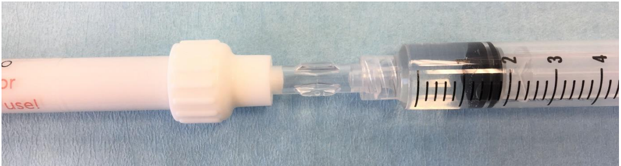
Abbildung 28: Aufbau Mischvorrichtung CaP-Zement
