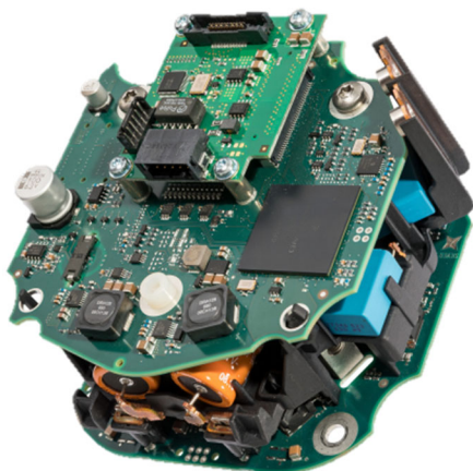
Abb. 4: Die Elektronik des Intelligent eQUALIZER. Oben die Rechnerplatine mit Diagnosemodul, unten die Leistungsplatine
