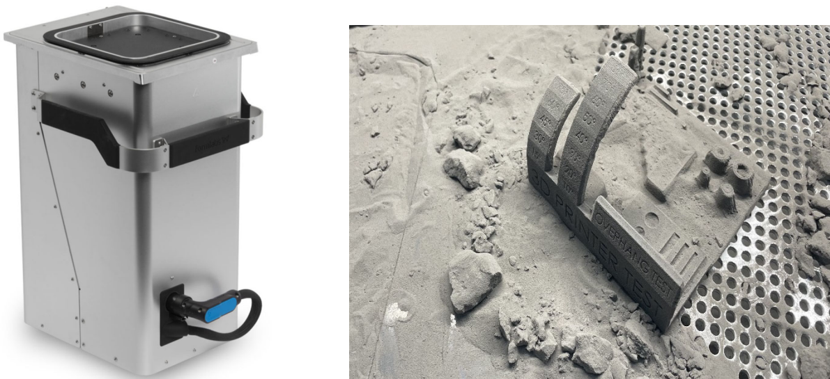
Abbildung 3: Rechts: Bauraumcontainer und links Bauteilentnahme im Arbeitsbereich der Nachbearbeitungs- und Reinigungsstation Fuse Sift [4]
