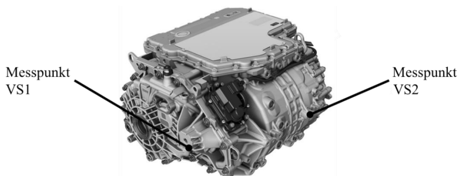
Abbildung 2.21: Kontaktpunkte der Körperschallmessung während der EOL Prüfung
