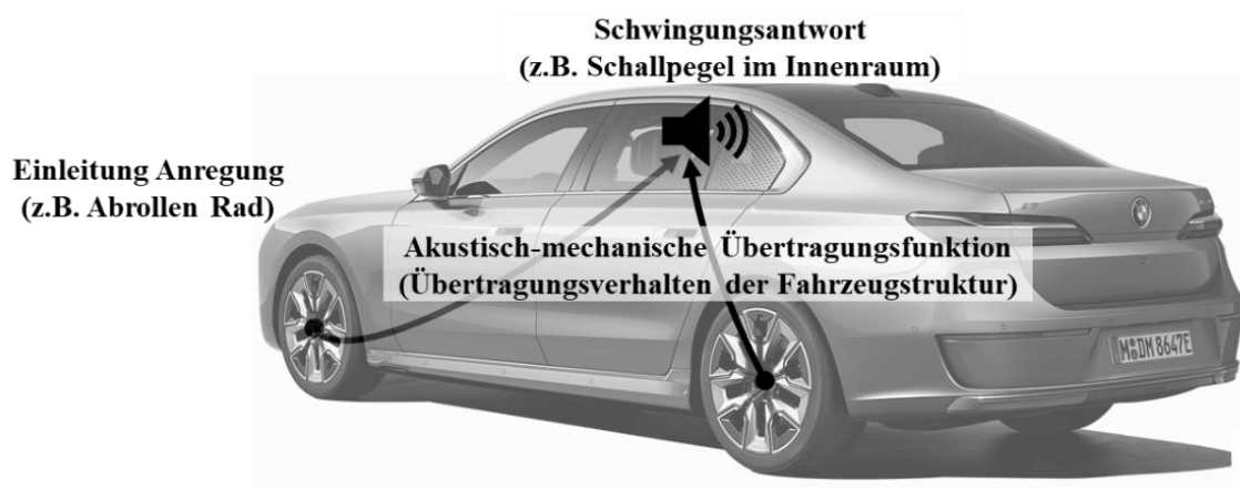
Abbildung 2.31: Schematische Darstellung einer akustisch-mechanischen Übertragung
