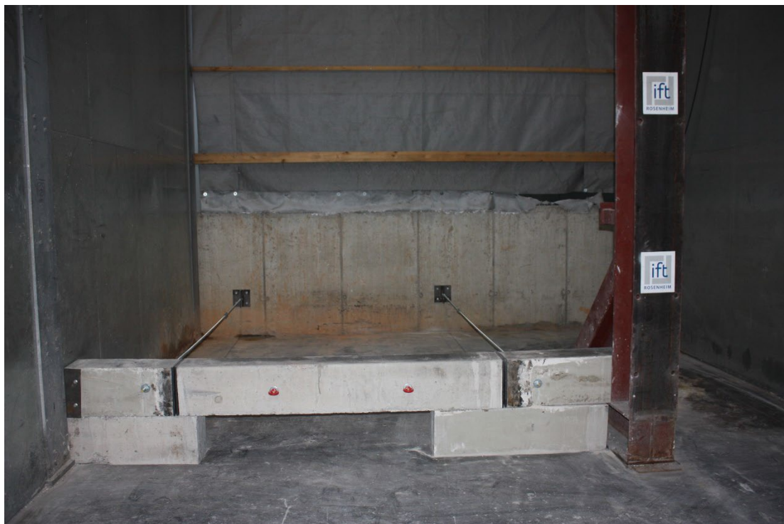
Abbildung 52: Rückverankerte Betonschwelle für den Auszugversuch
