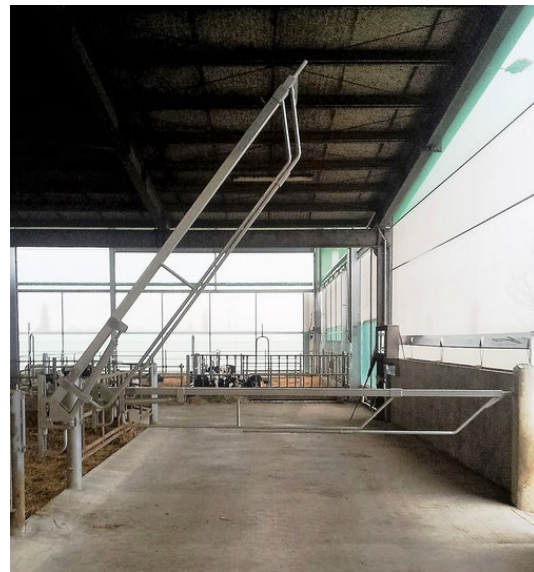
Abbildung 31: Teleskopschranke mit vertikaler Drehung; Quelle: www.stalltechnik24.de
