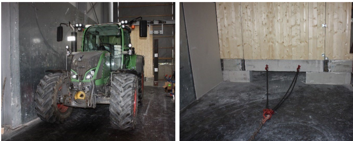
Abbildung 54: Traktor und Betonschwelle mit Holzaufbau
