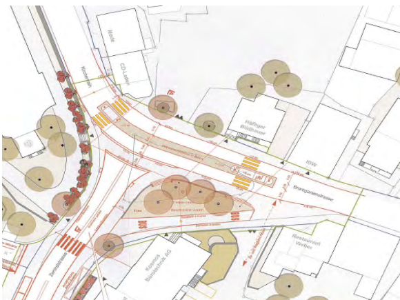
Abbildung 36 Rechtwinklig geführte, vortrittsbelastete Knotenzufahrt
