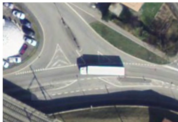
Abbildung 38 Einmündung mit ausgeweitetem Mittelbereich
