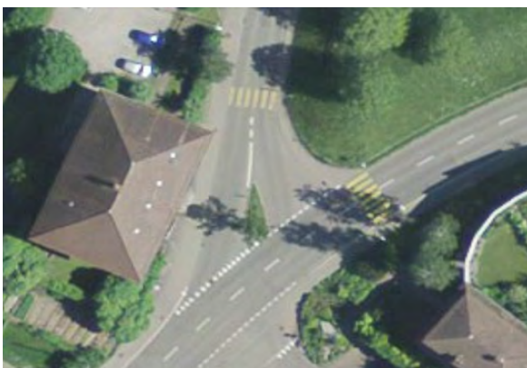
Abbildung 37 Spitzwinklig geführte vortrittsbelastete Knotenzufahrt
