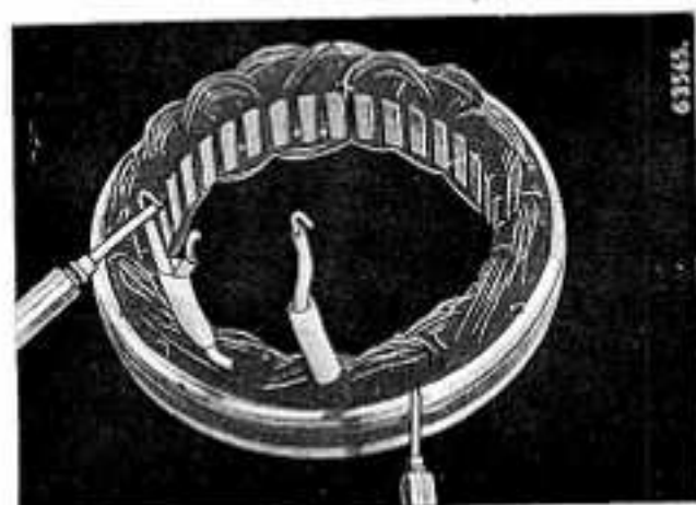
Bild 234 Prüfen der Leistungsstromwicklungen auf Masseschluß
