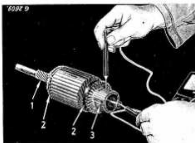
Bild 253 Ankerwicklung und Kollektor auf Masseschluß prüfen
