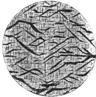
Fig. 6. Schnitt nach *P*, die Lage der Albitlamellen zeigend. (Vierfache Vergrößerung).
