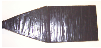
Abbildung 5.6: Ein mit Alufolie und anschliessend Klebeband umwickelter Szintillator. Die Alufolie dient zur Reflexion der Photonen und das Klebeband zur Abschirmung von Photonen aus der Umgebung. Dieser Szintillator kam bei den Experimenten zum Einsatz.
