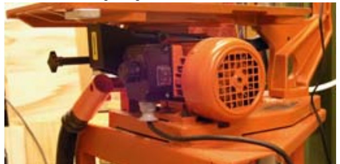
Seitenansicht der Maschine: Gut zu sehen der Asynchron-Wechselstrommotor mit Drehzahlregelung
