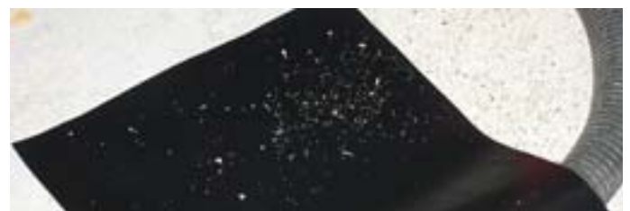
Ein Schnitt und der Dreck liegt am Boden. Verbesserungsbedarf bei der Staubabsaugung.
