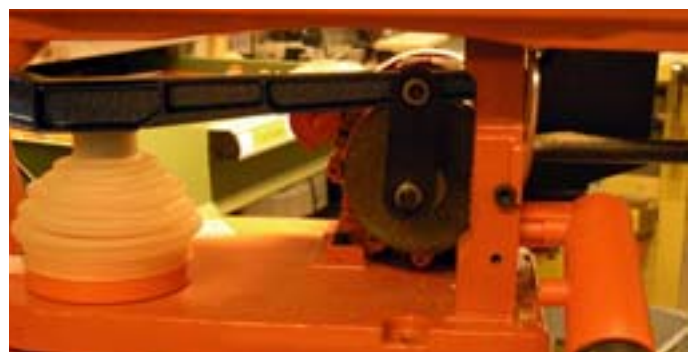
Selbstverständlich ist bei Hegner das ganze Pleuel kugelgelagert
