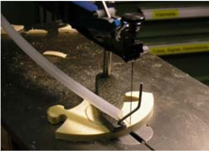
Ein wichtiger Beitrag zur Arbeitssicherheit: Der Werkstückniederhalter.
