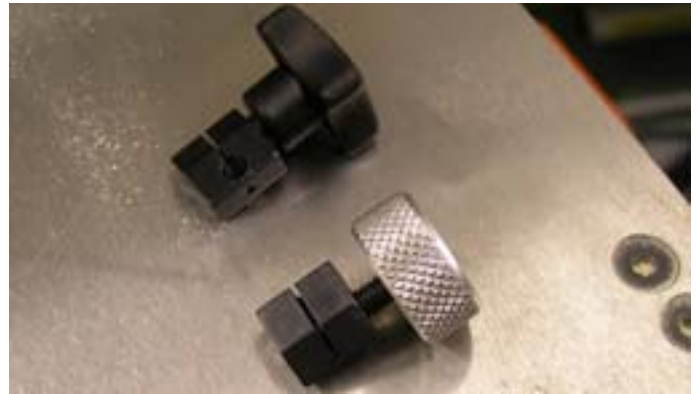
Schnellspanner erlauben einen werkzeuglosen Sägeblattwechsel - sehr nützlich bei Innenschnitten.
