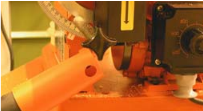
Verbesserungswürdig: Die Staubabsaugung
