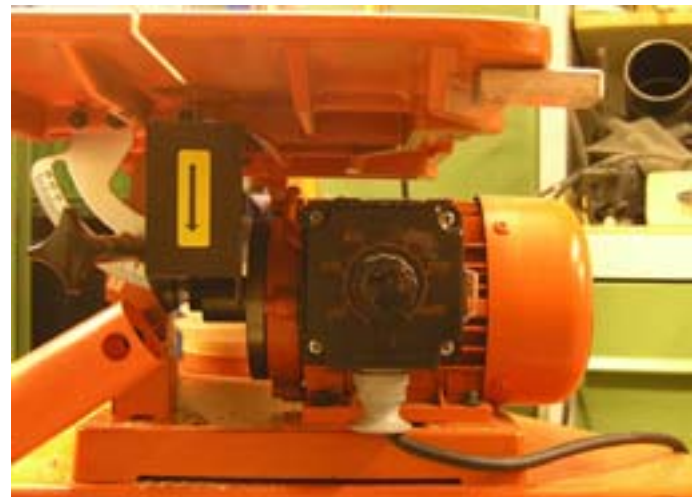
Frontansicht der Maschine. Deutlich zu sehen: Die von links angebrachte Staubabsaugung und die nach unten offene Sägeblattverdeckung. Bedauerliches Ergebnis: Staub, der nicht abgesaugt wurde.
