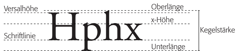
Abb. 3.2 : Das Liniensystem – hier lässt sich die Kegelstärke an Ober- und Unterlänge von p und h ablesen
