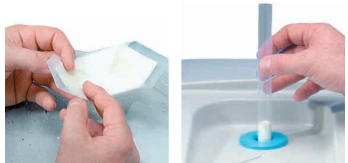
Schritt 2: Einrollen der getrockneten Probe im Trac Film
