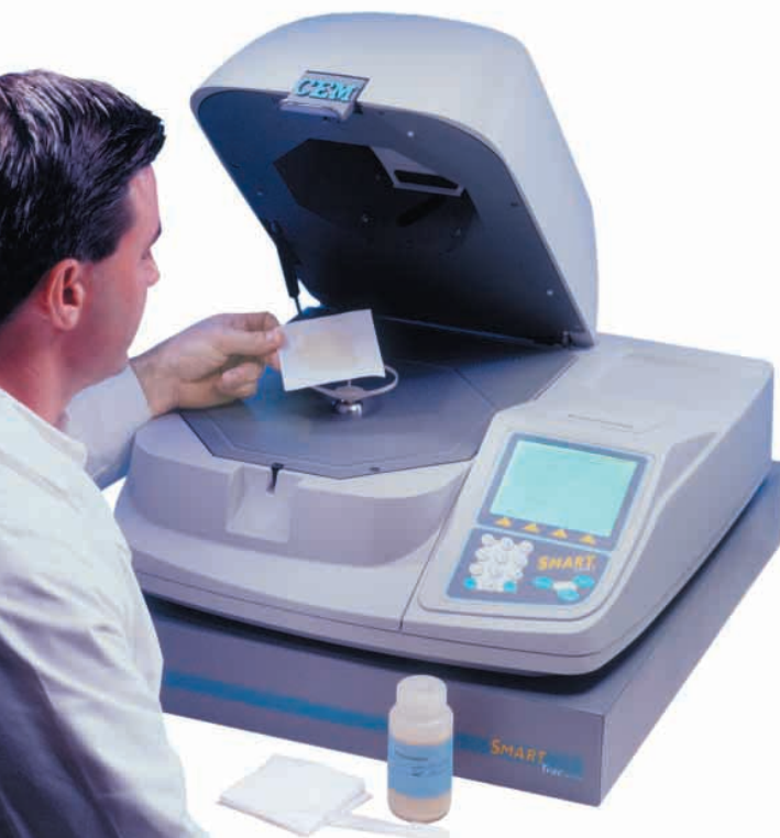
Schritt 1: Trocknen der Probe im Mikrowellentrockner
