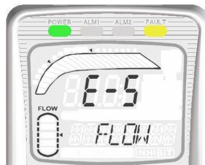
* E-5 FLOW (Auffälligkeiten der Durchflussrate)
