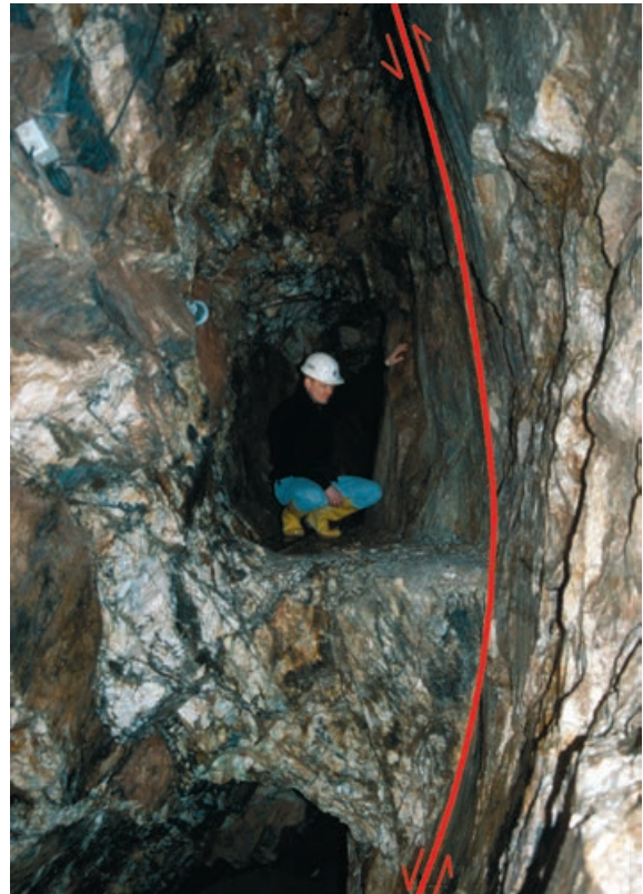
▲ Abb. 148 Abbau auf dem Schwerspatgang.
