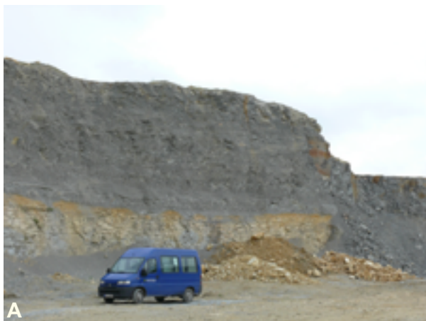
Abb. 3.2-23: Kalkstein, Mergelstein und Ölschiefer werden in Baden-Württemberg zur Zementherstellung im großen Umfang abgebaut. (A) Zementmergel der Mergelstetten-Formation über tonigen Kalksteinen im Tagebau Heidenheim a. d. Brenz (RG 7327-1). (B) Ölschiefer im Tagebau bei Dormettingen (RG 7718-4). Der Posidonienschiefer ist aufgrund seiner mineralogischen Zusammensetzung ein hochwertiger Rohstoff.
