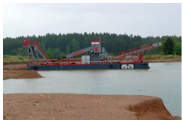
Abb. 3.3-24: Bei Hüfingen werden im Nassabbau mit dem Schwimmbagger Kiese für den Verkehrswegebau gewonnen (Kiesgrube Hüfingen, RG 8017-3).
