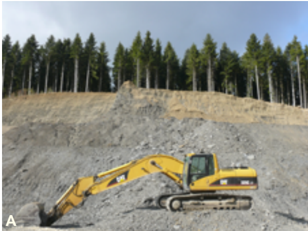
Abb. 3.2-25: Verschiedene Ziegeleirohstoffe werden in Baden-Württemberg abgebaut. (A) Gewinnung von Opalinuston aus dem Mittleren Jura in der Tongrube Schömberg/Withau (RG 7818-3). (B) Gebänderte bis laminierte, eiszeitliche Beckentone (Hasenweiler-Formation) in der Tongrube Herdwangen-Schönach-Großschönach (RG 8121-2).
