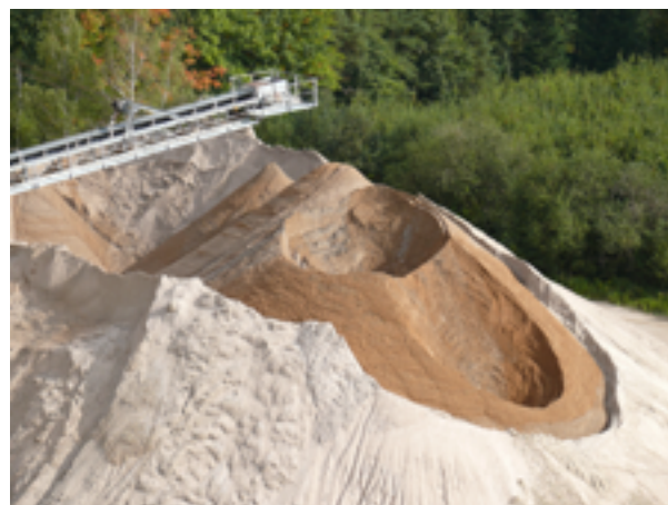
Abb. 4.4-5: In der Kiesgrube Malsch bei Karlsruhe (RG 7015-10) werden, wie in allen Abbaustätten im Oberrrheingraben, Kiese und Sande auf gemeinsamer Lagerstätte abgebaut und durch Siebung voneinander getrennt.
