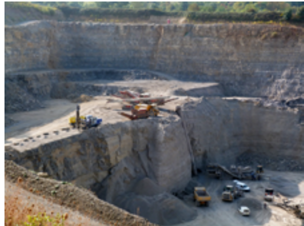
Abb. 1.3-1: Im Steinbruch Knittlingen bei Bretten (RG 6918-1) erfolgt der Abbau in mehreren Abbausohlen, sogenannten Bermen. Der Abraum wird in der Regel in einer eigenen Sohle abgetragen.
