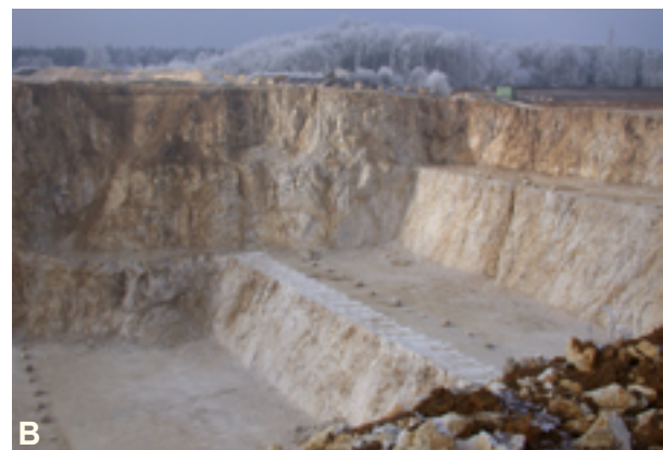
Abb. 3.2-29: Beispiele für hochreine Kalksteine in Baden-Württemberg. (A) Im Steinbruch Blaubeuren-Altental (RG 7624-2) auf der Schwäbischen Alb werden auf der unteren Sohle hochreine Massenkalksteine gewonnen. (B) Im Steinbruch Waibertal (RG 7227-1), nördlich von Heidenheim, werden die oberen zwei Sohlen (bräunliche Kalksteine) zur Gewinnung von Natursteinen genutzt. Auf den unteren Sohlen werden hochreine Kalksteine abgebaut.
