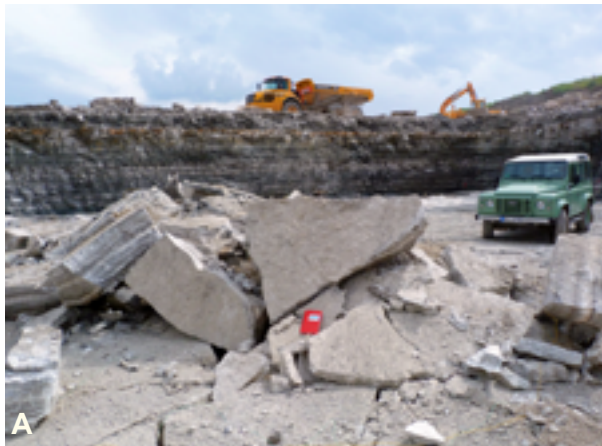
Abb. 3.3-21: Gewinnung und Verarbeitung von Sulfatgesteinen in der Region Schwarzwald-Baar-Heuberg. (A) Die Sulfatgesteine des Keupers werden für die Herstellung von Baustoffprodukten aus Gips und als Zumahlstoff in der Zementherstellung abgebaut (Gipssteinbruch Dietingen-Böhringen, RG 7717-6). (B) Herstellung von Gipskartonplatten im Werk Deißlingen der Fa. Knauf Gips KG (Werk Lauffen ob Rottweil, RG 7817-3).
