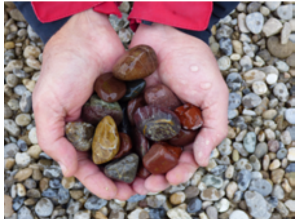
Abb. 3.2-8: Kies mit Radiolaritgeröllen aus der Grube Hartheim (RG 8011-3) im Oberrheingraben.
