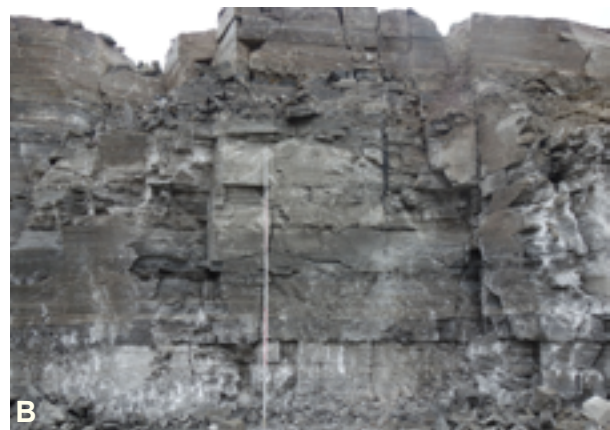
Abb. 3.3-6: Gewinnung von Sulfatgesteinen in der Region Heilbronn-Franken. (A) Gipsabbau in den Grundgipsschichten des Gipsbruchs Crailsheim-Triensbach (RG 6825-7). (B) Abbauwand in den Grundgipsschichten des Gipsbruchs Crailsheim-Hagenhof (RG 6826-7). An der Basis hellgrauer Gipsstein, darüber dunkelgraues Sulfatgestein mit wechselnd hohem Anhydritgehalt.
