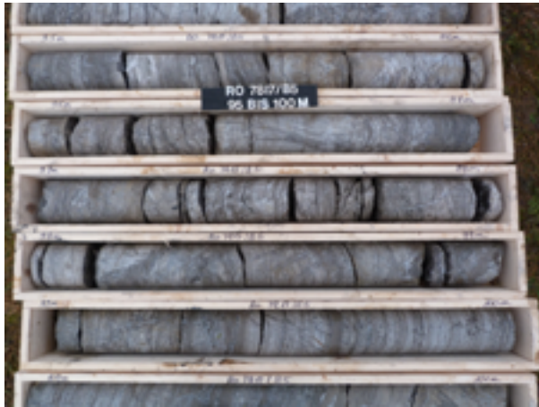
Abb. 2.1-9: Zur geologischen Aufnahme ausgelegte Bohrkern aus dem Mittleren Muschelkalk. Der Abschnitt zeigt eine gestörte Lagerung von z. T. geschichtetem, z. T. knollig ausgebildetem Gipsstein mit tonigen bis schluffigen Einschaltungen.
