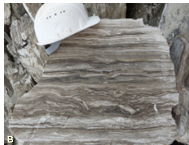
Abb. 3.2-31: Sulfatgesteine in Baden-Württemberg. (A) Die Grundgipsschichten mit Felsensulfat (unten) und Plattensulfat (oben) aus dem Mittleren Keuper in der Gipsgrube Vöhringen (RG 7617-3). (B) Im Bild ist ein charakteristisch gebänderter Block von Felsensulfat zu sehen. Gipsbruch Deißlingen-Lauffen (RG 7817-3) bei Rottweil.
