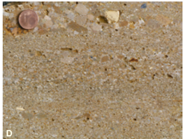
Abb. 3.2-27: Naturwerksteine aus Baden-Württemberg. (A) Sägearbeiten in einem Buntsandsteinbruch. (B) Allseitig gesägte Eisensandsteinblöcke, transportbereit für die weitere Verarbeitung in der Ulmer Münsterbauhütte. (C) Crailsheimer Muschelkalk, poliert, aus dem Steinbruch Satteldorf-Neidenfels (RG 6826-3). (D) Kalksandstein aus Britzingen mit Einschaltungen von Kalksteinbruchstücken in Mittel- und Grobkiesgröße. Die Probe stammt aus einem alten Steinbruch (RG 8112-1032) nördlich des Dammbachgrabens.
