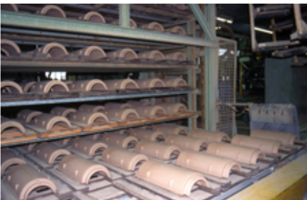
Abb. 3.3-15: Ehemalige Dachziegelproduktion im heute stillgelegten Werk Mühlacker (RG 7019-3).
