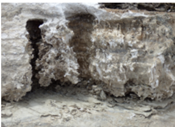
Abb. 4.4-15: Ablaugung und Lösung von Gipsstein im Gipsbruch Lauffen ob Rottweil (RG 7817-3).
