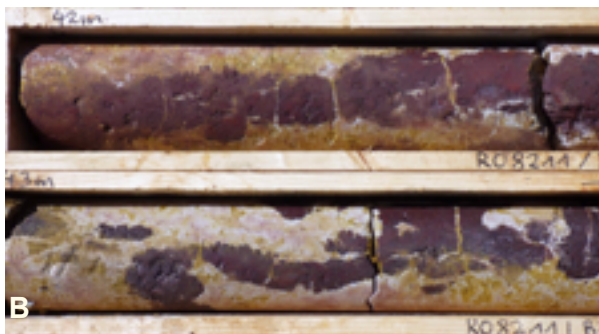
Abb. 2.1-32: Varietäten von Eisenerzen der Bohnerz-Formation (tBO) im Alttertiär bei Schliengen, Bohrkerne aus den LGRB-Forschungsbohrungen Ro8211/B7A und B7B (2017), abgeteuft östlich des Altinger Stollens. (A) Massiges Erzgemenge aus Goethit und Hämatit neben zwei Bruchstücken von bunten Bohnerzjaspis, eingebettet in weißlichen Kaolin-Quarzsand („Weißerde“) der Schliengen-Formation (tS); Abschnitt 44,84–45,00 m. (B) Bohrkerne im Abschnitt 42,0–43,5 m mit etwa senkrecht stehenden, röhren- bis spaltenartigen Anreicherungen eines Hämatit-Goethit-Erzgemenges in Kaolin-Quarzsand. Vermutlich während der diagenetischen Entwässerung des Sandes sind die „Erzröhren“ waagrecht durchgerissen; Sand drang in die Risse ein. Breite der Bohrkerne: 10 cm. (C) Kalksteinkonglomerate der Küstenkonglomerat-Formation (tKK) mit aus der Schliengen-Formation (tS) umgelagerten Bohnerzen (schwarzbraun) und großem Geröll aus der Hauptrogenstein-Formation (jmHR). Bohrkerne aus 16,6–16,7 m Tiefe.
