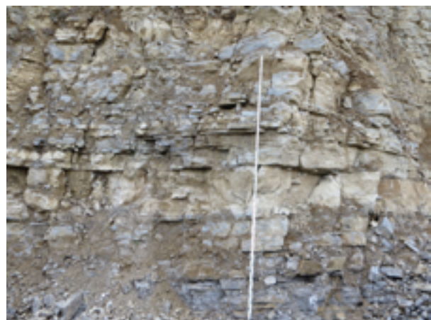
Abb. 2.1-8: Bankiger Trochitenkalk, Steinbruch Zimmern o. R.-Horgen (RG 7817-1, Länge des Maßstabs: 3 m).
