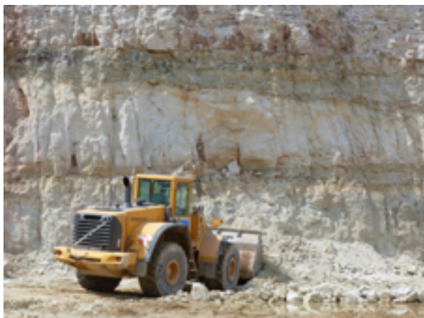
Abb. 3.2-14: Gewinnung von Mürbsandstein in der Sandgrube Kernen/Stetten (RG 7221-4).
