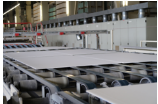
Abb. 4.4-11: Herstellung von Gipsplatten im Gipsplattenwerk der Fa. Knauf Gips KG in Deißlingen.
