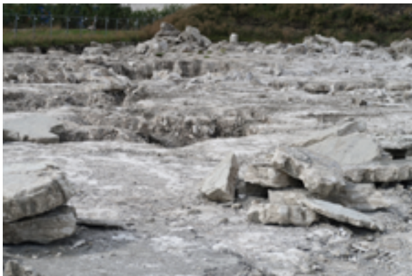
Abb. 4.4-14: Im Gipsbruch Lauffen ob Rottweil (RG 7817-3) werden Gipssteine der Unteren Grabfeld-Formation des Mittleren Keupers abgebaut. Lokal wird der Abbau durch starke Verkarstung und Verlehmung des Sulfatlagers behindert.
