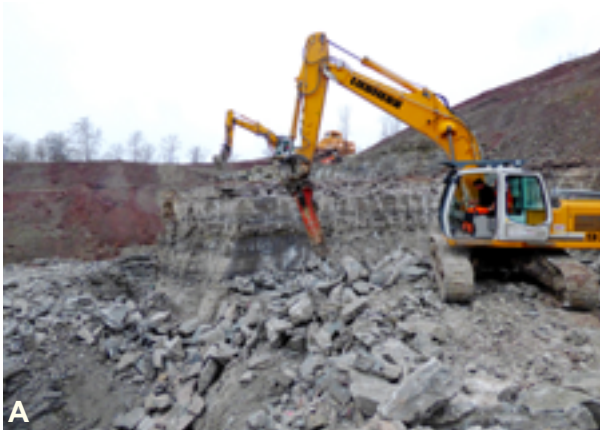
Abb. 3.3-6: Gewinnung von Sulfatgesteinen in der Region Heilbronn-Franken. (A) Gipsabbau in den Grundgipsschichten des Gipsbruchs Crailsheim-Triensbach (RG 6825-7). (B) Abbauwand in den Grundgipsschichten des Gipsbruchs Crailsheim-Hagenhof (RG 6826-7). An der Basis hellgrauer Gipsstein, darüber dunkelgraues Sulfatgestein mit wechselnd hohem Anhydritgehalt.
