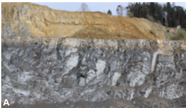
Abb. 3.3-30: Gewinnung von Zementrohstoffen in der Region Donau-Iller. (A) Abbauwand mit dunkelgrauen Mergelsteinen (unten) und hellen Kalkmergelsteinen (oben) der Mergelstetten-Formation im Zementsteinbruch Schelklingen-Vohenbronnen (RG 7624-5). Die Mischung beider Gesteine ergibt eine ideale Rohmischung zur Herstellung von Portlandzement. (B) Die als Hauptrohstoff zur Portlandzementherstellung besonders wichtigen dunkelgrauen Zementmergel wurden in Wannern zwischen Riffkörpern (weißlich bis hellgrau) und bei Meeresspiegelanstieg auch auf den Riffen abgelagert. Dabei starben die meisten Riffe ab, so dass dunkelgraue Mergel sowohl im selben Abbauniveau wie die Riffe als auch über diesen auftreten (RG 7624-13 Allmendingen-Mergelstetten).
