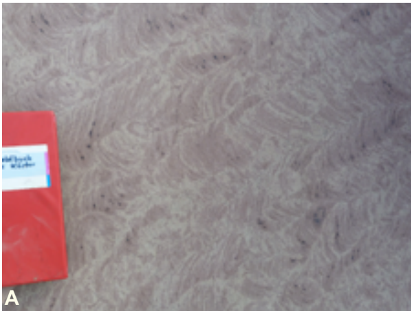
Abb. 3.3-14: Naturwerksteine sind regional verfügbare, natürliche Baumaterialien. (A) Schichtparallel geschnittener Schilfsandstein ist optisch attraktiv. (B) Die etwa 8–10 m hohe Schilfsandsteinwand im Steinbruch Maulbronn.
