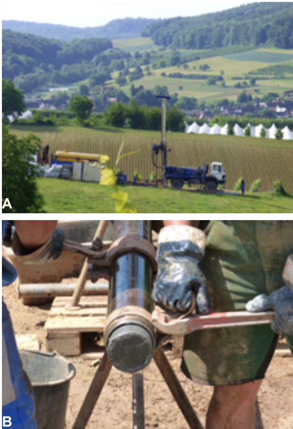
Abb. 2.1-31: Kernbohrarbeiten zur Erkundung der Bohnerz-vorkommen im Feld des Altinger Stollens, Gewinn Talröder östlich von Schliengen im Sommer 2017. (A) Bohranlage auf dem Bohrpunkt Ro8211/B7A, im Mittelgrund die Ortschaft Liel, im Hintergrund die Waldgebiete des Stocken und des Sonnholen. (B) Entnahme eines Bohrkerns aus dem Kernrohr, hier kurz vor der Endteufe in den Mergelsteinen der Kandern-Formation (jmKA).
