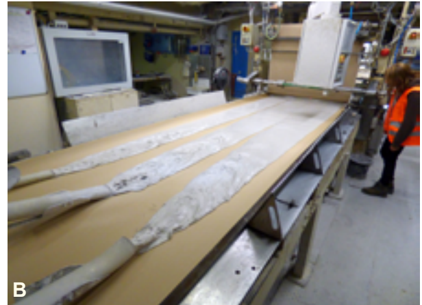
Abb. 3.3-21: Gewinnung und Verarbeitung von Sulfatgesteinen in der Region Schwarzwald-Baar-Heuberg. (A) Die Sulfatgesteine des Keupers werden für die Herstellung von Baustoffprodukten aus Gips und als Zumahlstoff in der Zementherstellung abgebaut (Gipssteinbruch Dietingen-Böhringen, RG 7717-6). (B) Herstellung von Gipskartonplatten im Werk Deißlingen der Fa. Knauf Gips KG (Werk Lauffen ob Rottweil, RG 7817-3).
