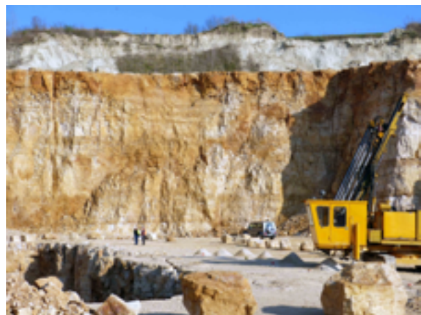
Abb. 1.3-2: Die verschiedenen Abbausohlen werden z. B. im Steinbruch Merdingen (RG 7912-2) bei der Gewinnung des Hauptrogensteins als Arbeitsfläche für Sprengarbeiten genutzt.
