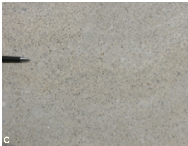
Abb. 3.2-27: Naturwerksteine aus Baden-Württemberg. (A) Sägearbeiten in einem Buntsandsteinbruch. (B) Allseitig gesägte Eisensandsteinblöcke, transportbereit für die weitere Verarbeitung in der Ulmer Münsterbauhütte. (C) Crailsheimer Muschelkalk, poliert, aus dem Steinbruch Satteldorf-Neidenfels (RG 6826-3). (D) Kalksandstein aus Britzingen mit Einschaltungen von Kalksteinbruchstücken in Mittel- und Grobkiesgröße. Die Probe stammt aus einem alten Steinbruch (RG 8112-1032) nördlich des Dammbachgrabens.
