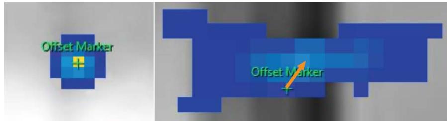
Abb. 93: Wenn die Offset-Markierung nicht im Zentrum des erwärmten Bereichs erscheint, die Offset-Markierung manuell ins Zentrum des erwärmten Bereichs ziehen.
