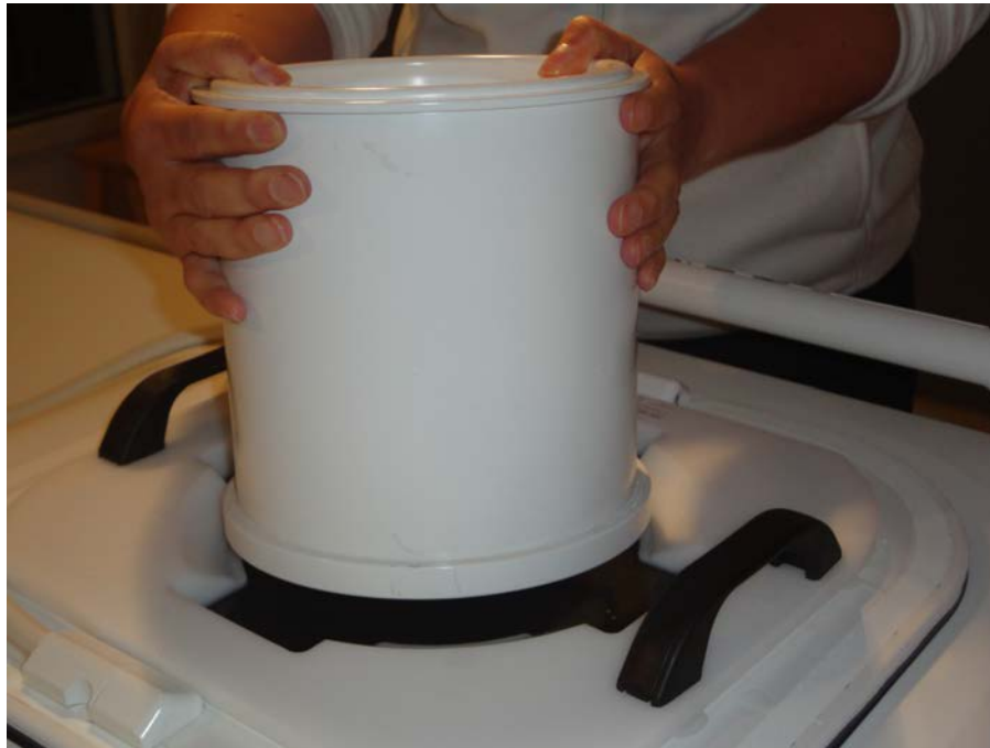
Abb. 113: Absetzen einer Kante des QS-Phantoms auf der Phantomplatte. Vorsichtiges Ablassen des QS-Phantoms auf die Phantomplatte.
