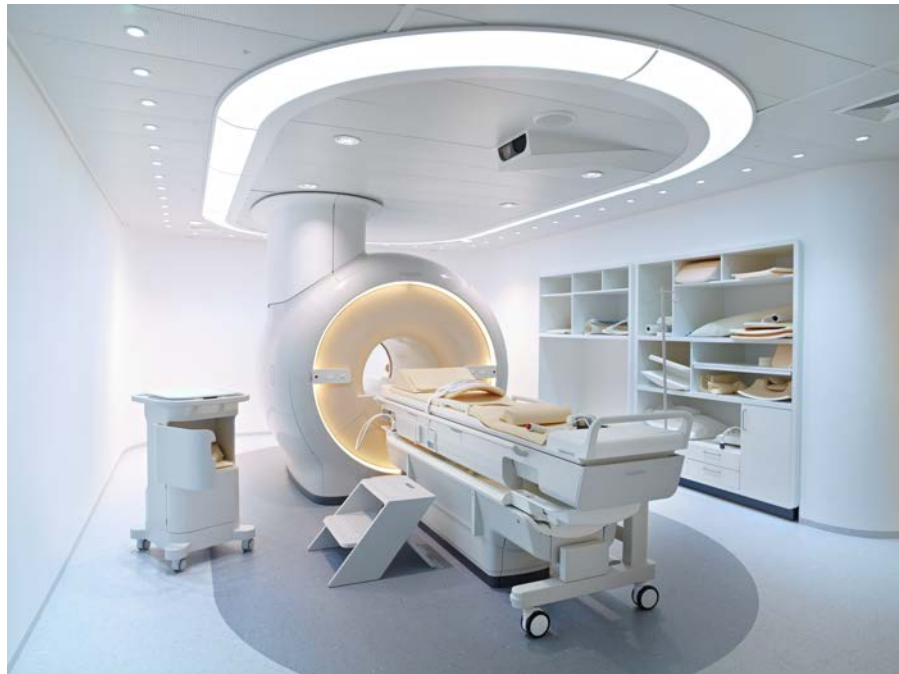
Abb. 2: An den Scanner montierte Sonalleve-Tischplatte
