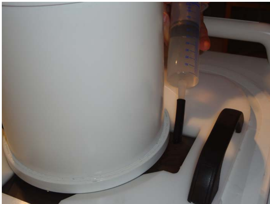
Abb. 114: Auffüllen verbleibender Lufttaschen mit entgastem Wasser.
