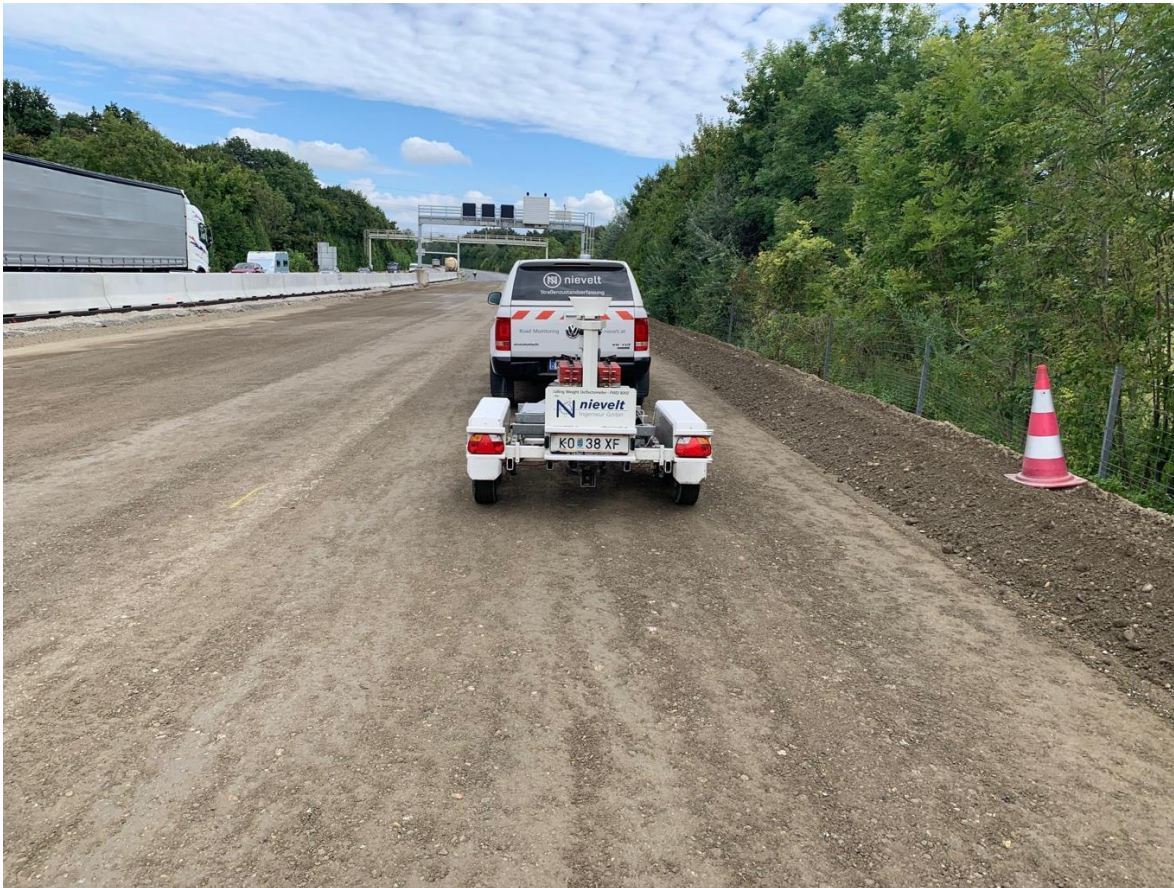
Abbildung 15: Im Rahmen des Projektes durchgeführte Tragfähigkeitsmessungen mit dem dynamischen Fallgewichtsdeflektometer
