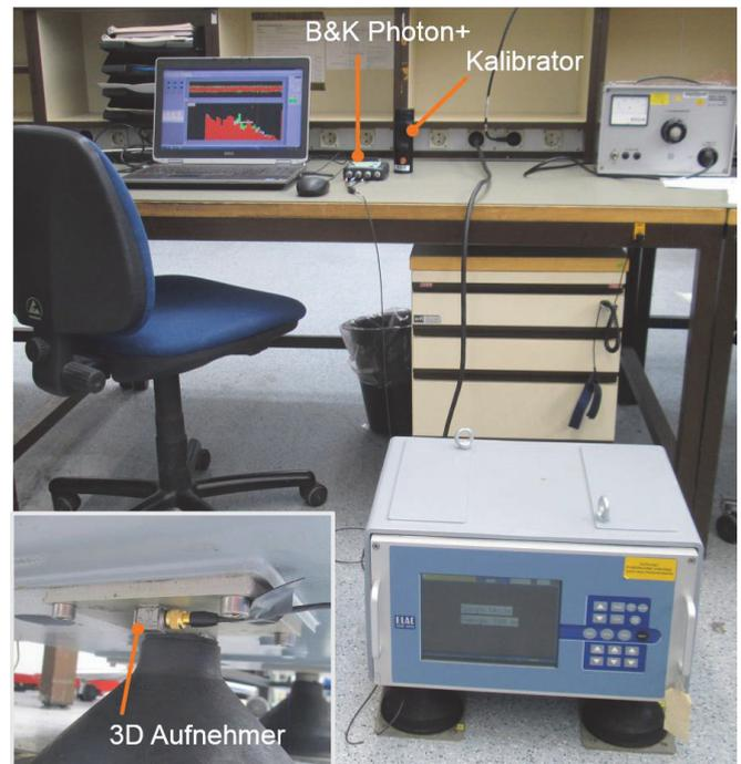
Abbildung 4: Messplatz mit SEB 5900, unten links Detail Befestigung des 3D Beschleunigungsaufnehmers
