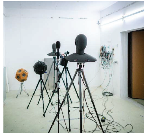
Abbildung 4: Akustische Messungen sowie binaurale Kunstkopfaufnahmen im Türenprüfstand.
