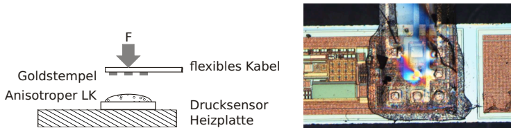
Abbildung 7.5: Schema und Foto der Anbindung flexibler Strukturen an ein dünnes Polyimidkabel mit Hilfe von anisotropem Leitklebstoff
