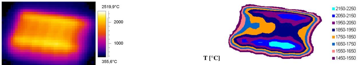
Abb. H.11: IR-Bild und Oberflächentemperaturprofil bei einer Elektronenstrahlbelastung von 18.1 MW/m<sup>2</sup>
