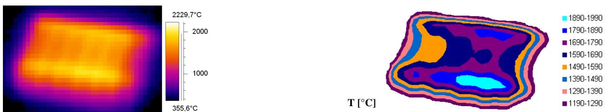
Abb. H.8: IR-Bild und Oberflächentemperaturprofil bei einer Elektronenstrahlbelastung von  $16,2 \text{ MW/m}^2$
