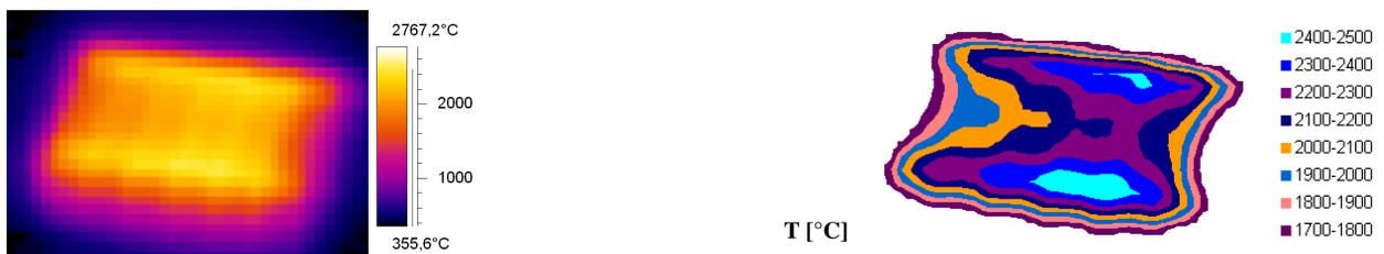
Abb. H.14: IR-Bild und Oberflächentemperaturprofil bei einer Elektronenstrahlbelastung von 21 MW/m<sup>2</sup>
