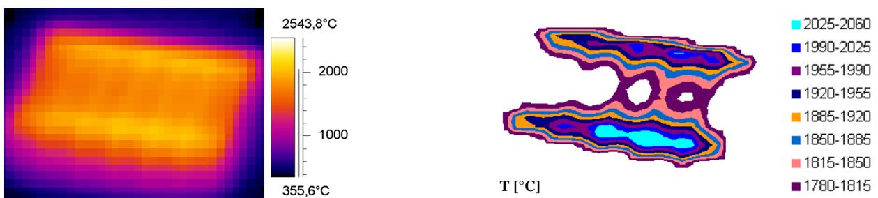
Abb. H.36: IR-Bild und Oberflächentemperaturprofil bei einer Elektronenstrahlbelastung von 20 MW/m<sup>2</sup>, Zyklus 10
