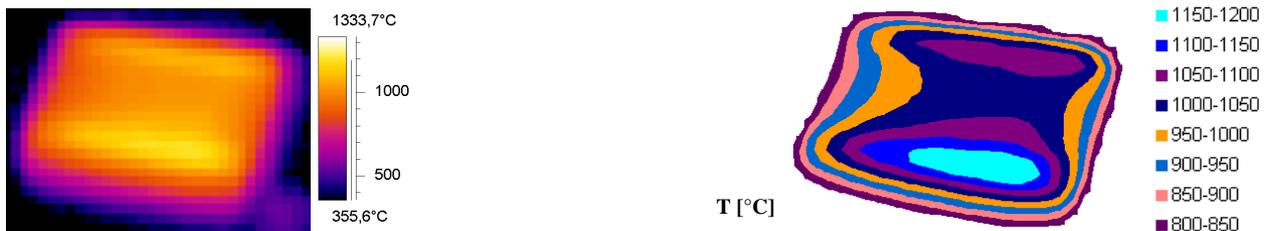
Abb. H.33: IR-Bild und Oberflächentemperaturprofil bei einer Elektronenstrahlbelastung von  $15.9 \text{ MW/m}^2$
