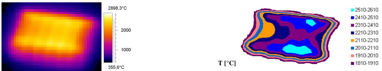
Abb. H.16: IR-Bild und Oberflächentemperaturprofil bei einer Elektronenstrahlbelastung von  $22.8 \text{ MW/m}^2$
