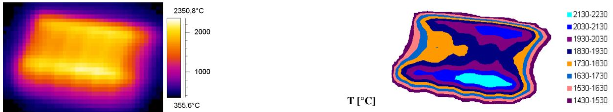
Abb. H.10: IR-Bild und Oberflächentemperaturprofil bei einer Elektronenstrahlbelastung von 18.1 MW/m<sup>2</sup>
