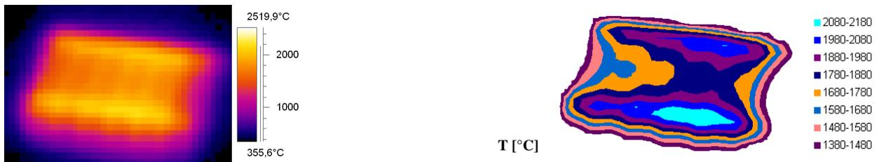
Abb. H.12: IR-Bild und Oberflächentemperaturprofil bei einer Elektronenstrahlbelastung von 19.3 MW/m<sup>2</sup>
