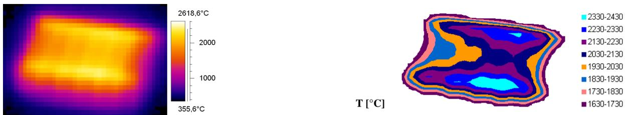
Abb. H.13: IR-Bild und Oberflächentemperaturprofil bei einer Elektronenstrahlbelastung von 20 MW/m<sup>2</sup>
