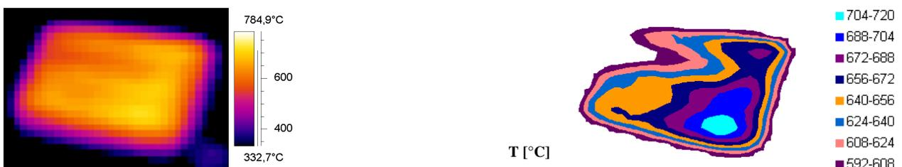
Abb. H.26: IR-Bild und Oberflächentemperaturprofil bei einer Elektronenstrahlbelastung von  $9.1 \text{ MW/m}^2$
