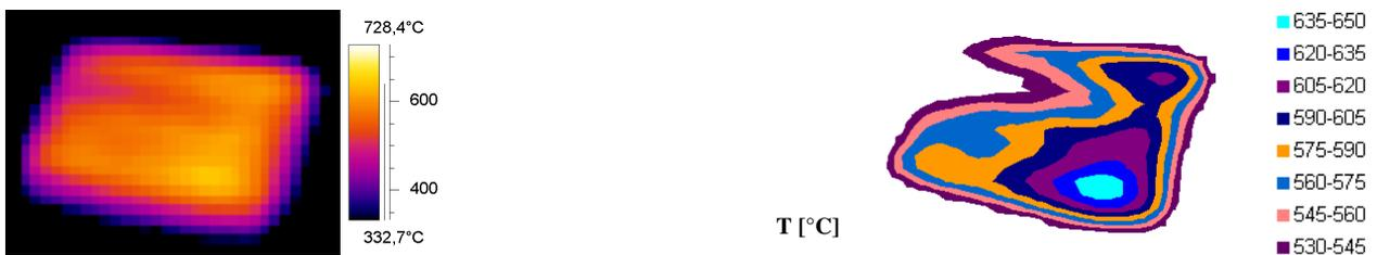
Abb. H.25: IR-Bild und Oberflächentemperaturprofil bei einer Elektronenstrahlbelastung von  $7.9 \text{ MW/m}^2$
