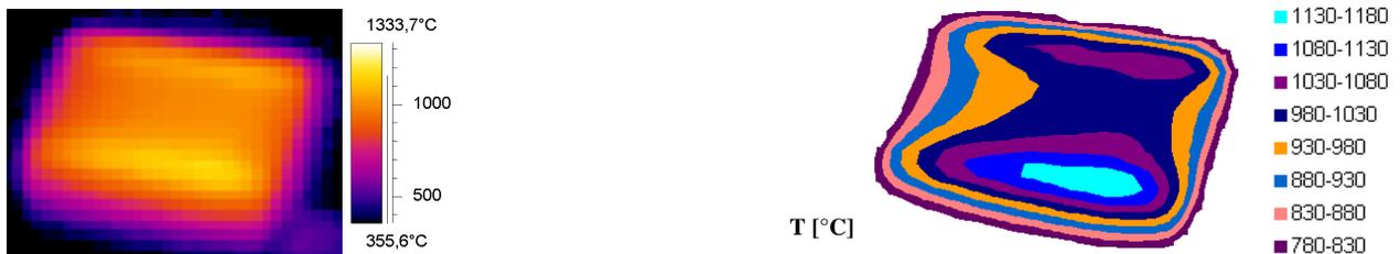
Abb. H.32: IR-Bild und Oberflächentemperaturprofil bei einer Elektronenstrahlbelastung von  $14.7 \text{ MW/m}^2$
