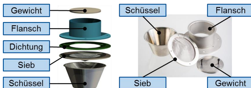
Abbildung 2: Prinzipieller Aufbau der konstruierten Ausblutapparatur
