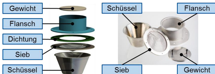
Abbildung 5: Prinzipieller Aufbau der konstruierten Ausblutapparatur [Fis18]
