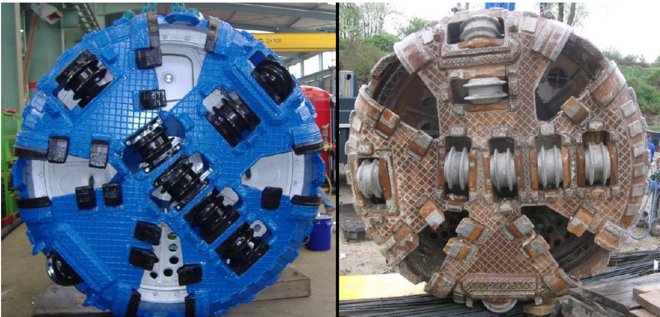
Abbildung 4.4: Schneidrad vor und nach erster Haltung [24]
