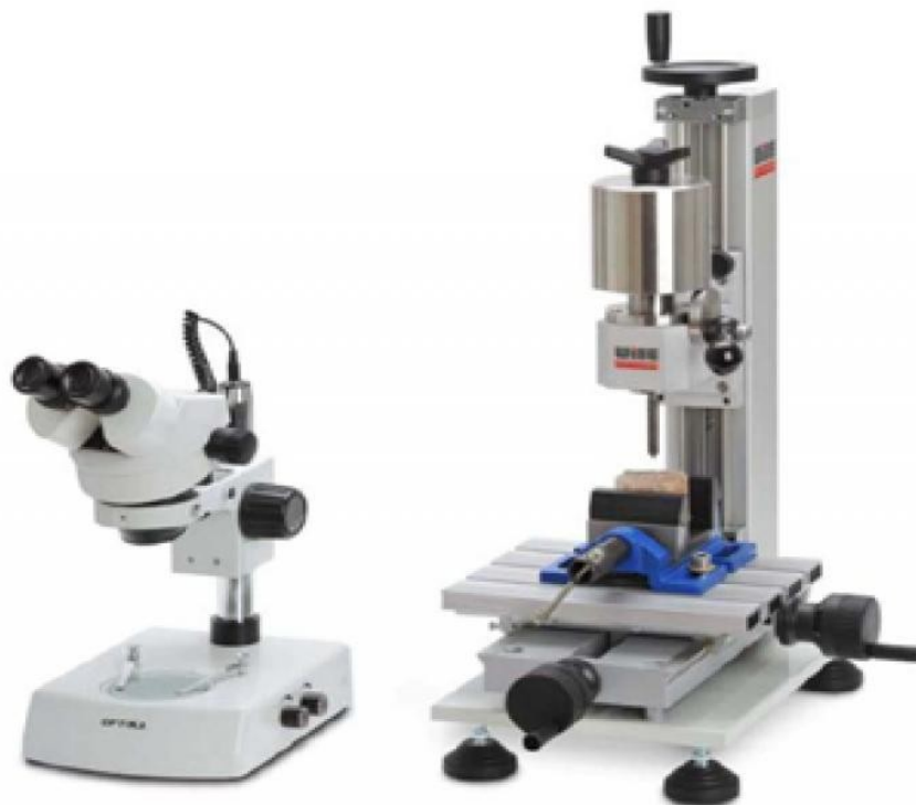
Abbildung 3.1: Cerchar - Abrasivitätstestgerät (rechts) und Binokular (links) für die Ermittlung des CAI [12]
