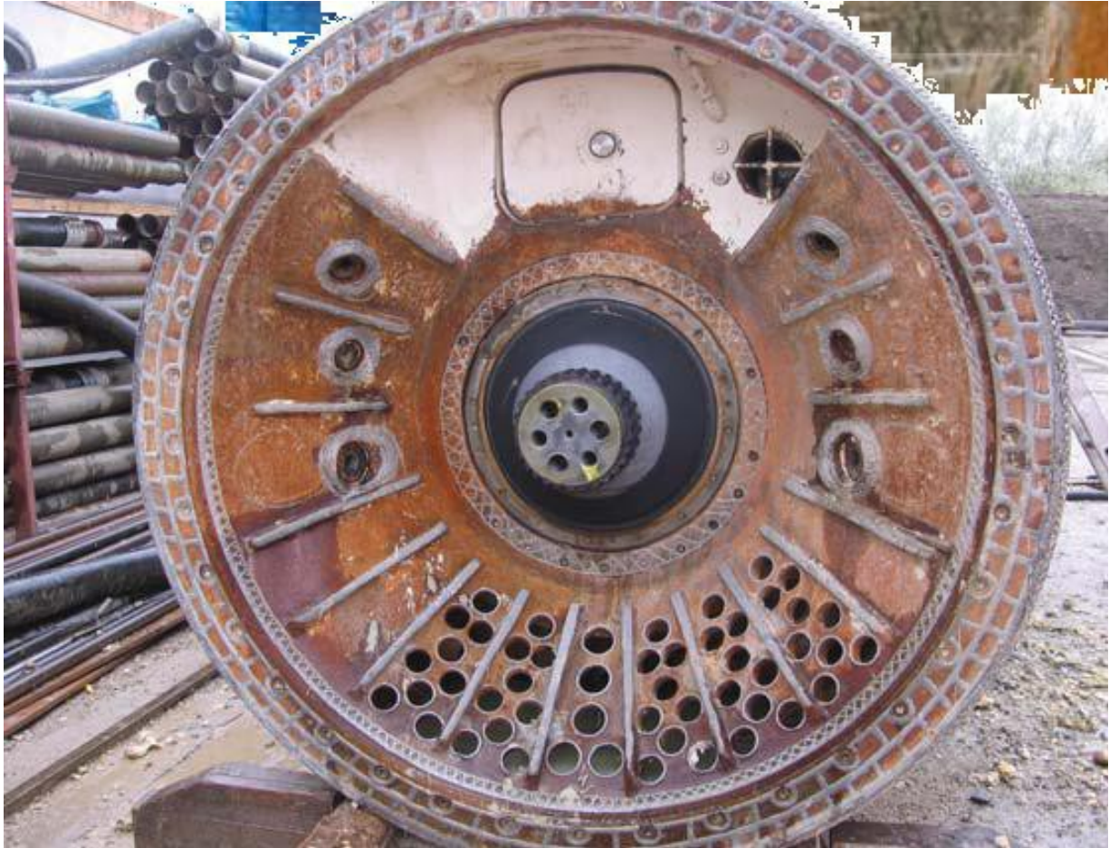
Abbildung 4.9: Brecherraum; deutlich sind die Brecherleisten als silbrige Streifen zu erkennen. Die Öffnungen im unteren Viertel sind der Rechen des Brecherraumes.
