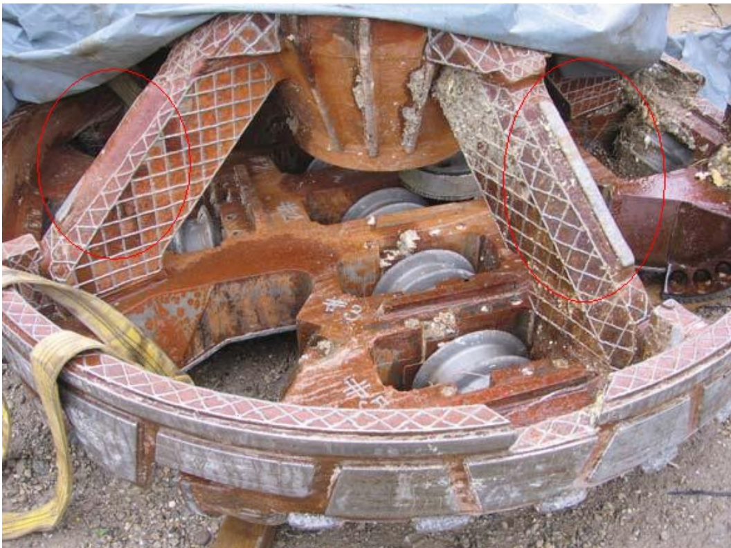
Abbildung 4.8: Schneidradrückseite mit Brecherleisten (rot umrandet)
