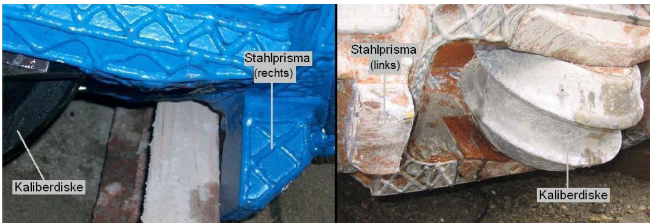
Abbildung 4.5: Verschleiß an Kaliberdiske und Stahlprisma [24]
