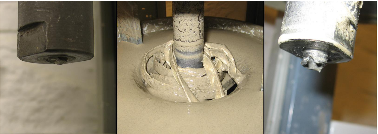
Abbildung 5.8: Links: Bruchbild der Fixierschraube des 70 mm Passstückes; Mitte: Umwicklung der Welle mit Gummidichtung; Rechts: Bruchbild der Fixierschraube des 45 mm Passstückes
