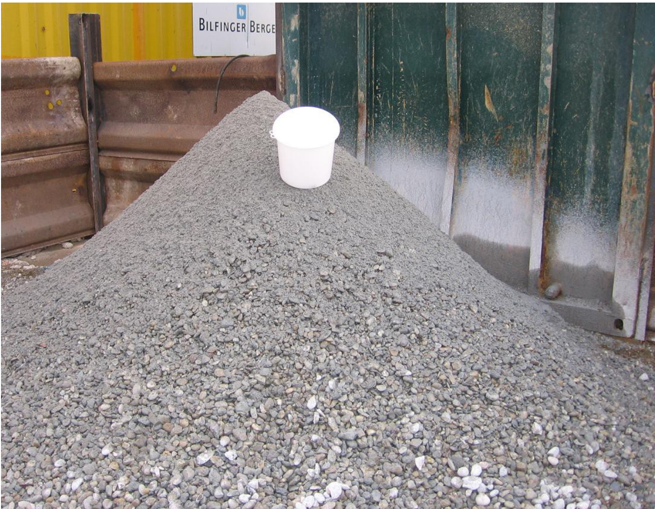
Abbildung 5.1: Schüttkegel der Separieranlage
