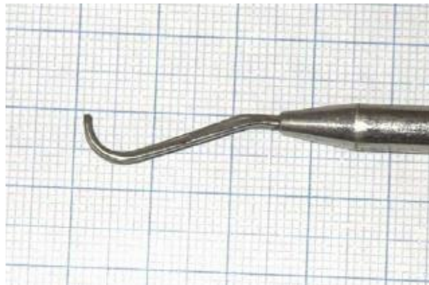
Abbildung 3.3: Vergrößerte Kopfansicht der SVUSS/3 Kobrasonde [3]
