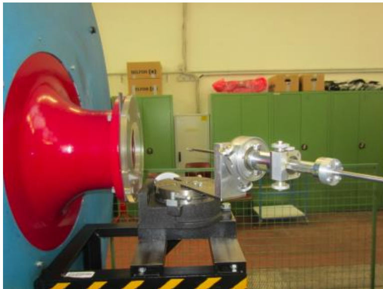
Abbildung 5.3: Einspannung der Sonde vor der Düse [2]
