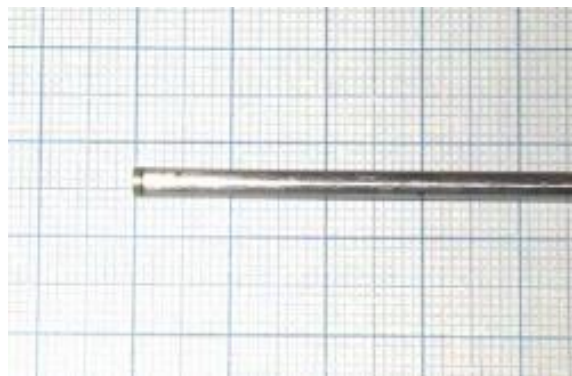
Abbildung 3.7: Vergrößerte Kopfansicht der AVA Zylindersonde Nr. 43 [3]
