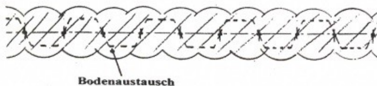
Abb. 5.3: Bodenaustausch bei Spundwänden [14, Abb. E-137]
