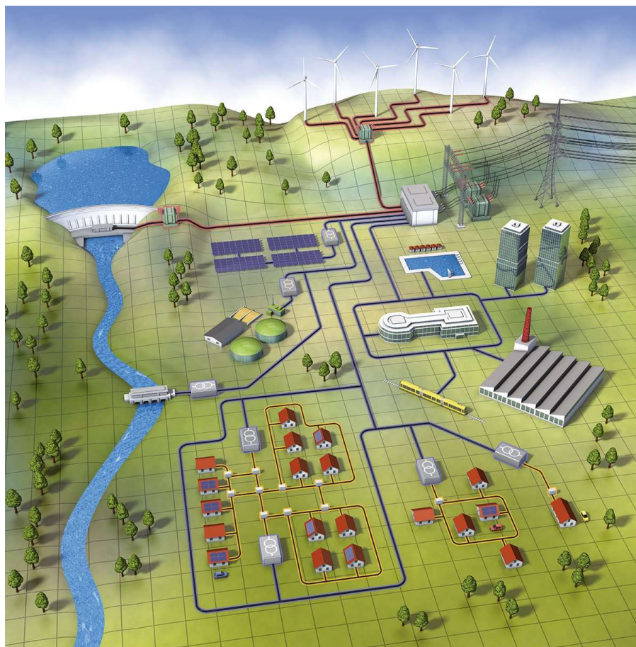
Abb. 2: Stromnetz mit Hoch- Mittel- und Niederspannungsebene [Janiz]
